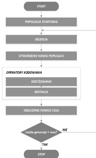
Rys. 2. Schemat blokowy algorytmu genetycznego
