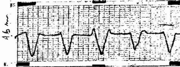
Rys.4. Profilogram powierzchni obrabianej przedmiotu uzyskany szlifowaniem wcinającym narzędziem \sigma_m = 0,42 \text{ mm}
