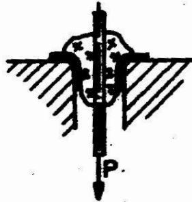
Rys. 2. Metoda badania wytrzymałości statycznej [3]
