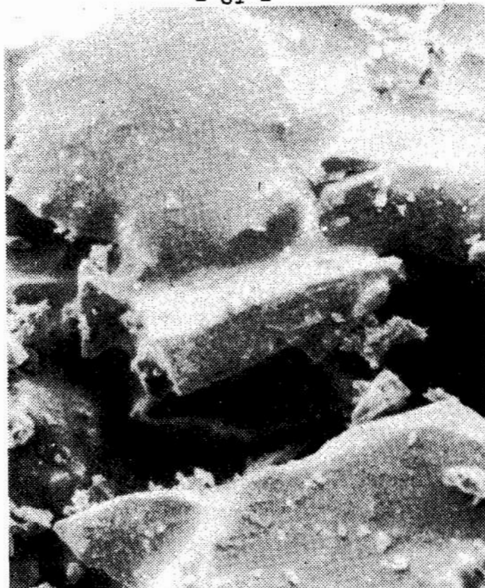
Fot. 3. Powierzchnia przełomu próbki ściernicy po wtórnej obróbce termicznej. Pow. 300x.
