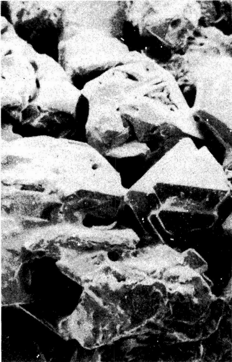
Rys. 9. Fragment ceramicznej ściernicy diamentowej, do wyrobu której użyto ziarno diamentowe powlekane stopioną mieszaniną szkieł i dewitryfikatów z wypełniaczem elektrokorundowym i wypalanej w temperaturze 1100^{\circ}\text{C} . Powiększenie 100 x.
