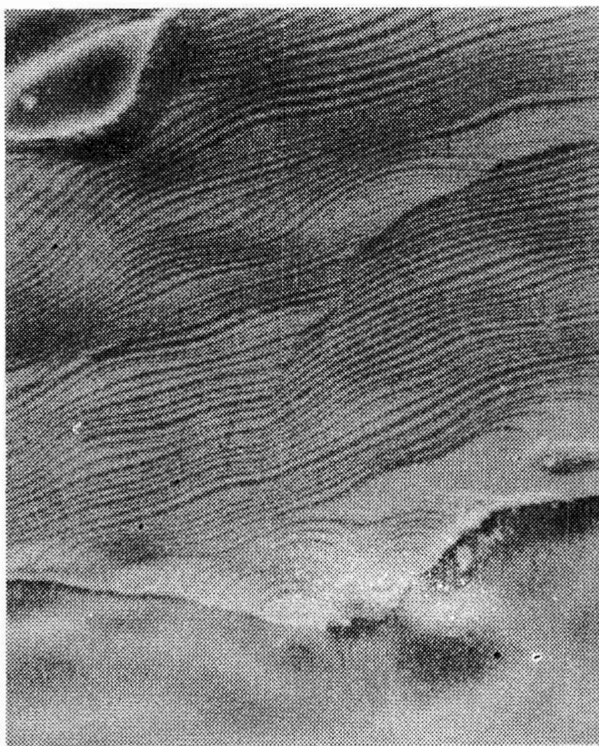
Fot. 3. Powierzchnia ziarna po obróbce termicznej w temp. 1900°C w której zapoczątkowany został wcześniej proces rekrytalizacji. W temperaturze tej rekrytalizacja objęła całe ziarno i zatrzymana została na granicy z sąsiednim ziarnem. Powiększenie \times 1000
