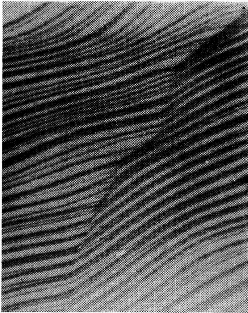
Fot. 4. Powierzchnia zrekrystalizowanego ziarna. Powiększony fragment z Fot. 3. Próbkę przygotowano przez napylenie złotem jak w p. 1, 2, 3. Powiększenie \times 3000
