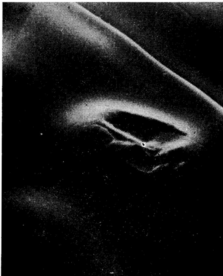
Fot. 2. Powiększony fragment z Fot. 1 z przedstawionym pękniętym pęcherzem. Na krawędzi pęcherza widoczne charakterystyczne schodkowe płaszczyzny zapoczątkowujące proces rekrytalizacji ziarna. Próbkę przygotowano przez napylenie złotem. Powiększenie \times 3000
