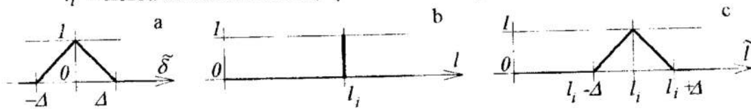
Rys. 5. Funkcja charakterystyczna odległości pomiędzy cechami obiektu: a) błąd pomiaru, b) odległość katalogowa, c) odległość rozmyta (LR)
