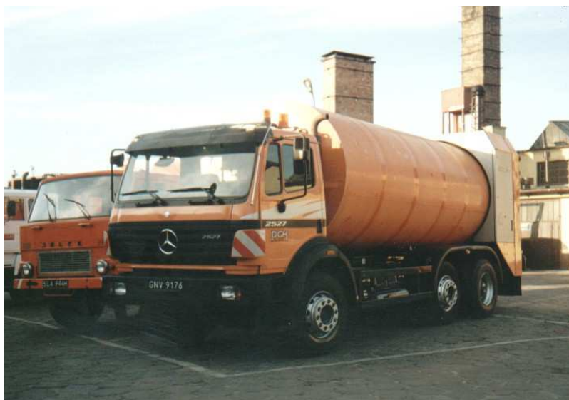
Rys. 6. Samochód bezpylny do opróżniania pojemników typu SM 110, 120, 240, 1100 Fig. 6. Dustless lorry for emptying bins and containers of SM 110, 120, 240, 1100 types
