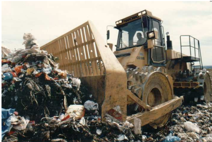
Rys. 19. Ubijarko-spycharka „Kompaktor” ciężar 28 ton
