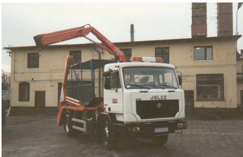
Rys. 7. Samochód bramowy do przewozu kontenerów z odpadami i surowcami z żurawiem do rozładunku Fig. 7. Gate lorry for transportation of containers with waste and recycled materials with attached crane for unloading
