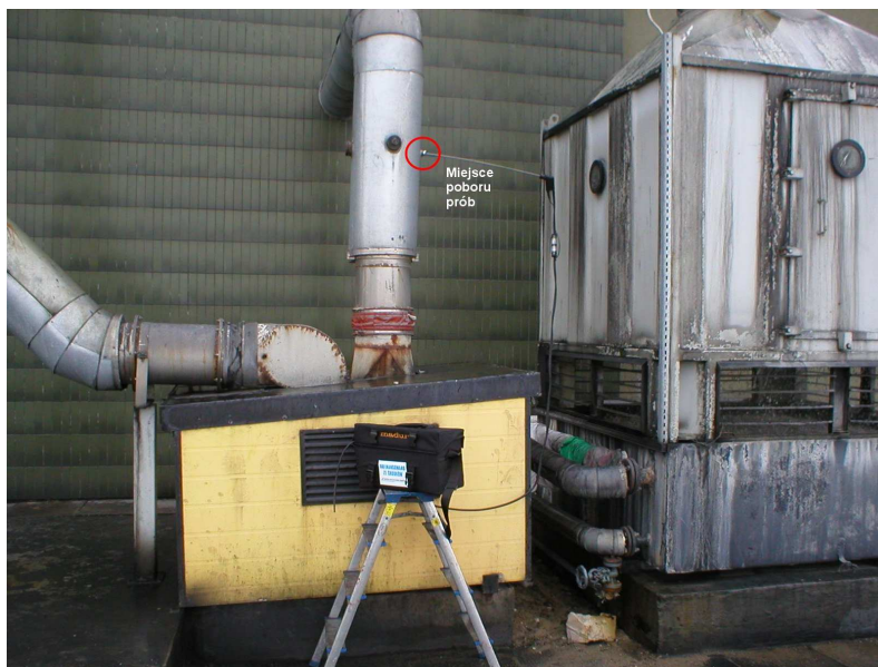
Rys. 8. Punkt pomiarowy stężeń zanieczyszczeń – wentylator wyciągowy Fig. 8. Measurements point of pollutants concentrations – outtake fan
