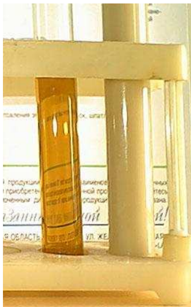
Rys. 2. Wizualne porównanie próbek oleju I20A przed (po prawej), a po oczyszczeniu (po lewej)
