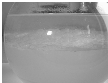
Olej napędowy zakażony przez mikroorganizmy Pseudomonas aeruginosa
