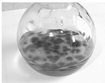
Olej napędowy zakażony przez drożdże Candida i grzyby Cladosporium reinae
