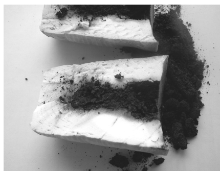
Rys. 7. Zanieczyszczenia stałe zatrzymane podczas oczyszczania popłuczyn ze zbiornika paliwego
