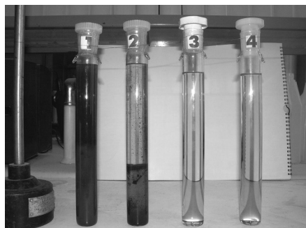
Rys. 6. Wyniki oczyszczania popłuczyn ze zbiornika paliwego: 1 – popłuczyny; 2 – popłuczyny po 3 dobach klarowania w temperaturze pokojowej; 3 – benzyna po filtracji; 4 – odseparowana woda
