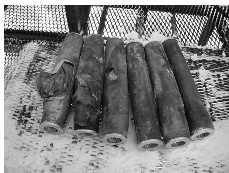
Rys. 10. Zniszczone filtry importowane Fig. 10. Destroyed imported filters
