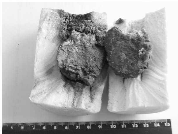
Rys. 3. Sztuczne zanieczyszczenia zatrzymane przez wkład filtrujący
