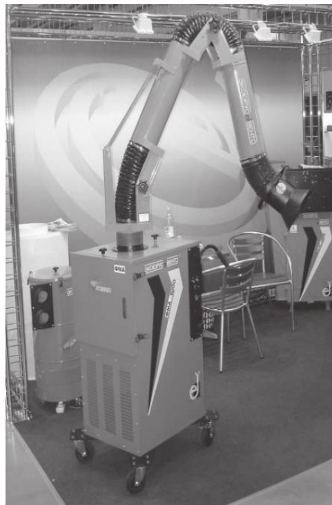
Rys. 2. Urządzenie z ssącym ramieniem obrotowym i z autonomicznym blokiem filtrująco-wentylacyjnym Fig. 2. The rotary-lifting device with the self-contained filtering&ventilating unit
