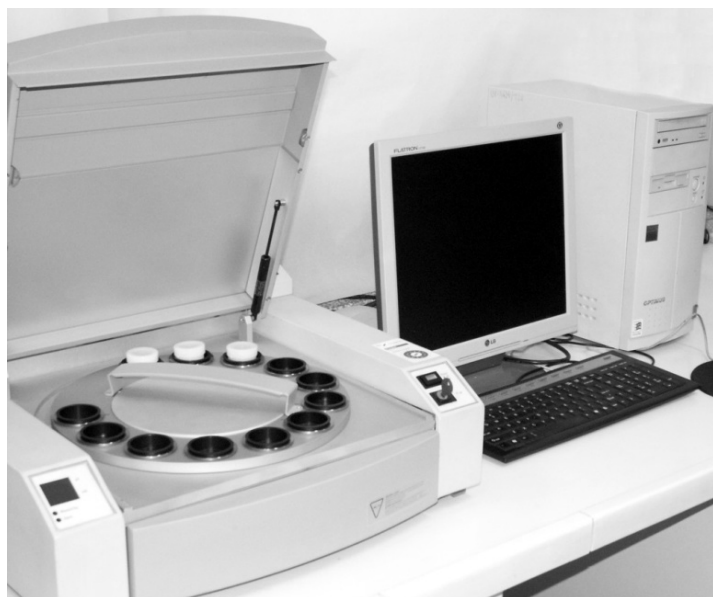
Fot. 2. Widok spektrometru rentgenowskiego MiniPal PW4025. Laboratorium Katedry Techniki Wodno-Mułowej i Utylizacji Odpadów Politechniki Koszalińskiej
