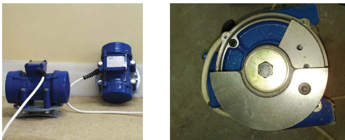
Rys. 6. Wibratory elektryczne rotacyjne, sposób regulacji sił
