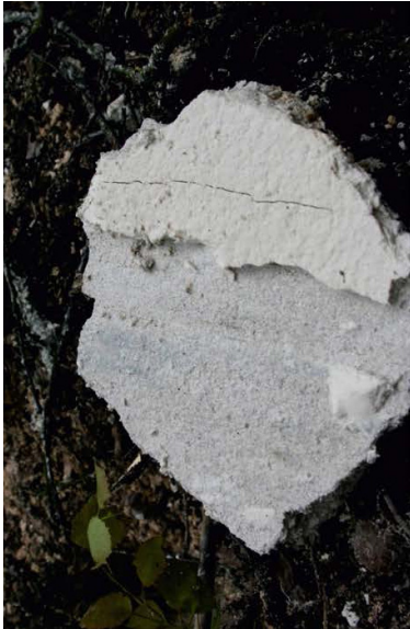
Fot. 3. Próbka warstwy zbitej z odkrywki nr 4, głębokość 36–39 cm ppt [fot. M. Gliniak]
