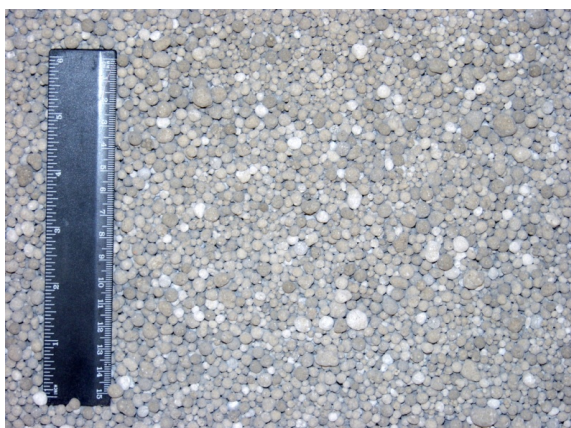
Rys. 1. Granulat przygotowany na bazie popiołu z kotła odzysknicowego oraz popiołu z filtrów workowych instalacji spalania odpadów komunalnych
