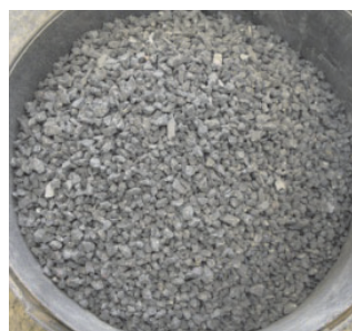
Rys. 1. Widok kruszywa wtórnego uzyskanego z próbek betonu BWW, frakcje 2–4 oraz 4–8 mm
