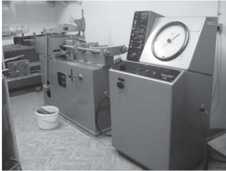
Rys. 1. Użyty do badań średniowymiaryowy aparat bezpośredniego ścinania Fig. 1. Medium-size direct shear box apparatus used for tests
