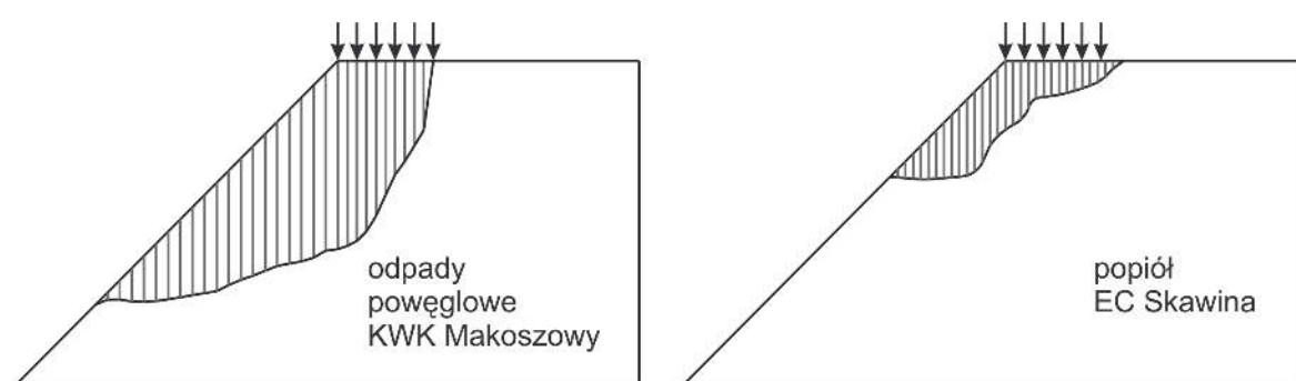
Rys. 9. Profile analizowanych brył osuwiskowych
