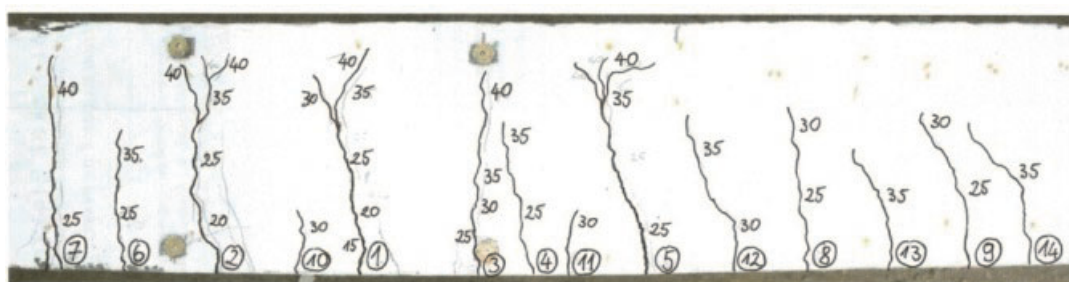
Rys. 6. Kształtowanie się i rozwój rys belki A wraz z podanymi wartościami obciążenia w kN
