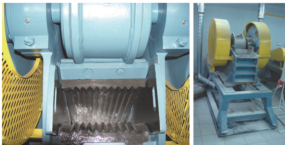
Rys. 5. Komora robocza oraz ogólny widok doświadczalnej kruszarki szczękowej L44.41 produkcji Makrum S.A., fot. T. Gawenda
