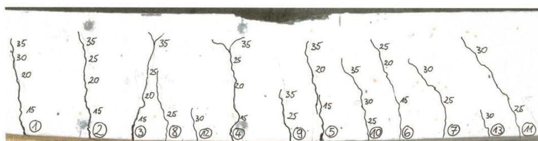
Rys. 7. Kształtowanie się i rozwój rys belki C wraz z podanymi wartościami obciążenia w kN
