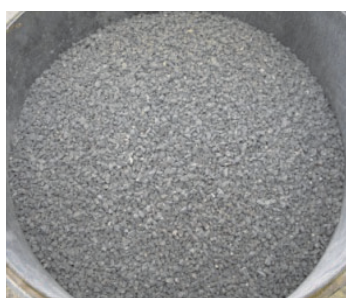
Rys. 1. Widok kruszywa wtórnego uzyskanego z próbek betonu BWW, frakcje 2–4 oraz 4–8 mm
