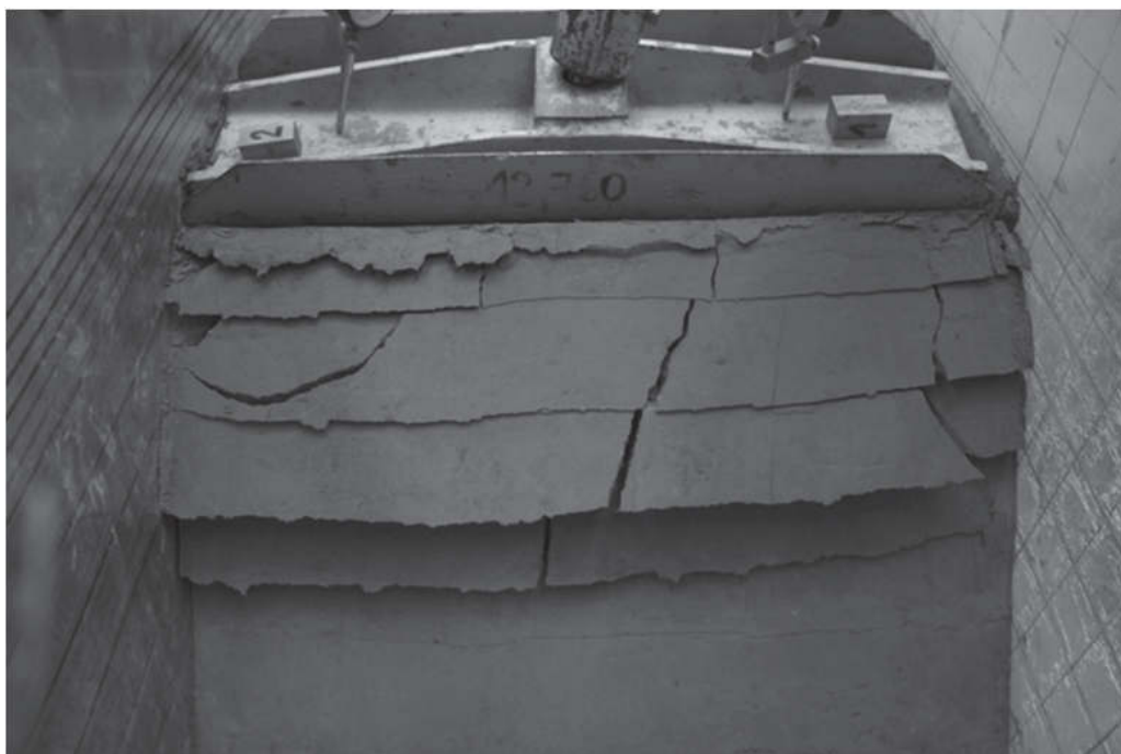
Rys. 5. Deformacje modelu nasypu z popiołów lotnych na skutek utraty stateczności
