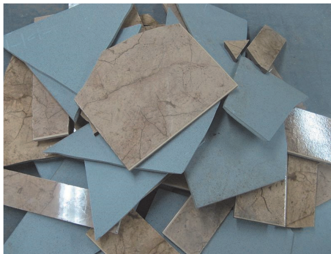
Rys. 3. Odpady wyrobów płytek ceramicznych, fot. A. Walerak Fig. 3. Waste from ceramic tails production (photo: A. Walerak)
