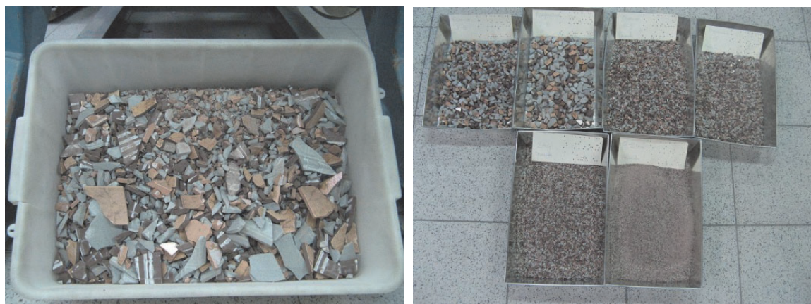
Rys. 7. Produkt po I stadium (z lewej) i po II stadium kruszenia (z prawej), fot. A. Walerak
