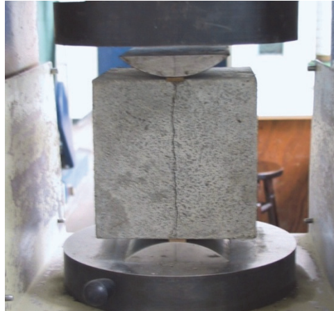
Fig. 3.4. Cube specimen after splitting tensile test (photo by J. Domski) Rys. 3.4. Próbką sześcienna po badaniu wytrzymałości na rozciąganie przy rozłupywaniu (foto J. Domski)
