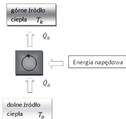
Rys. 1. Zasada transportu energii w pompie ciepła
