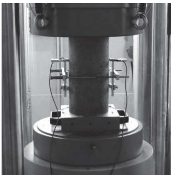
Rys. 2. Ogólny widok stanowiska do badania modułu sprężystości Fig. 2. Overall view of the position to study the elasticity module
