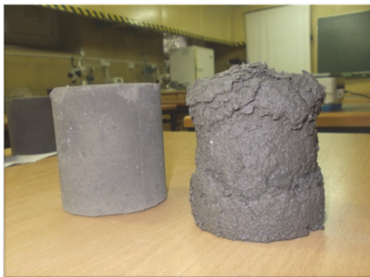
Rys. 1. Widok próbek poddanych pielęgnacji powietrznej (lewa) i pielęgnacji powietrzno-wodnej z 14 cyklami zamrażania i odmrażania (prawa) (fot. E. Gałowicz)
