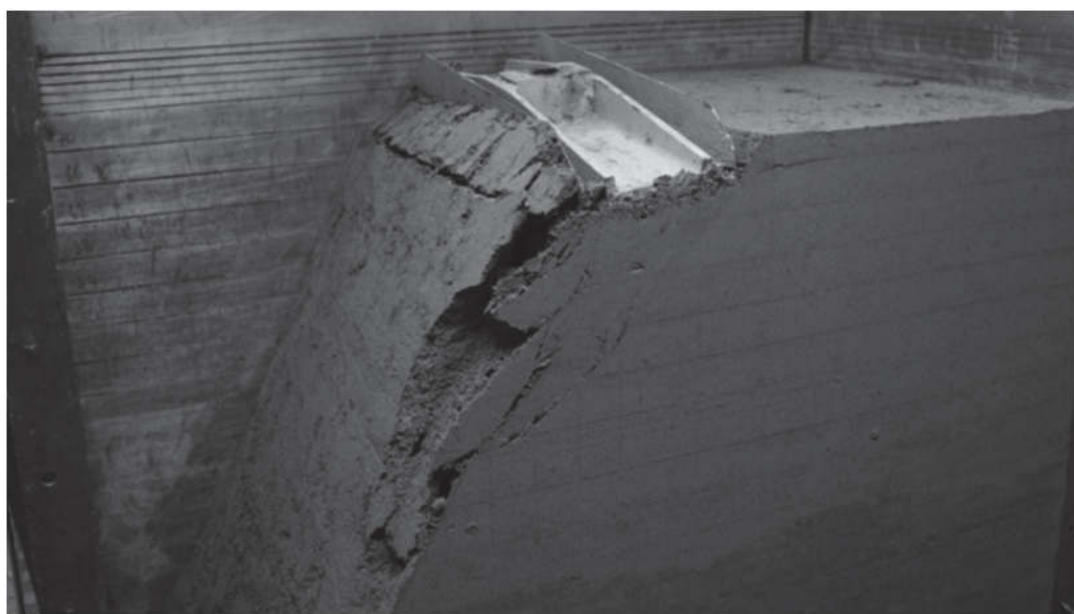
Rys. 4. Deformacje modelu nasypu z popioło-żużla na skutek utraty stateczności – skarpa o nachyleniu 60^\circ (fot. P. Baran)
