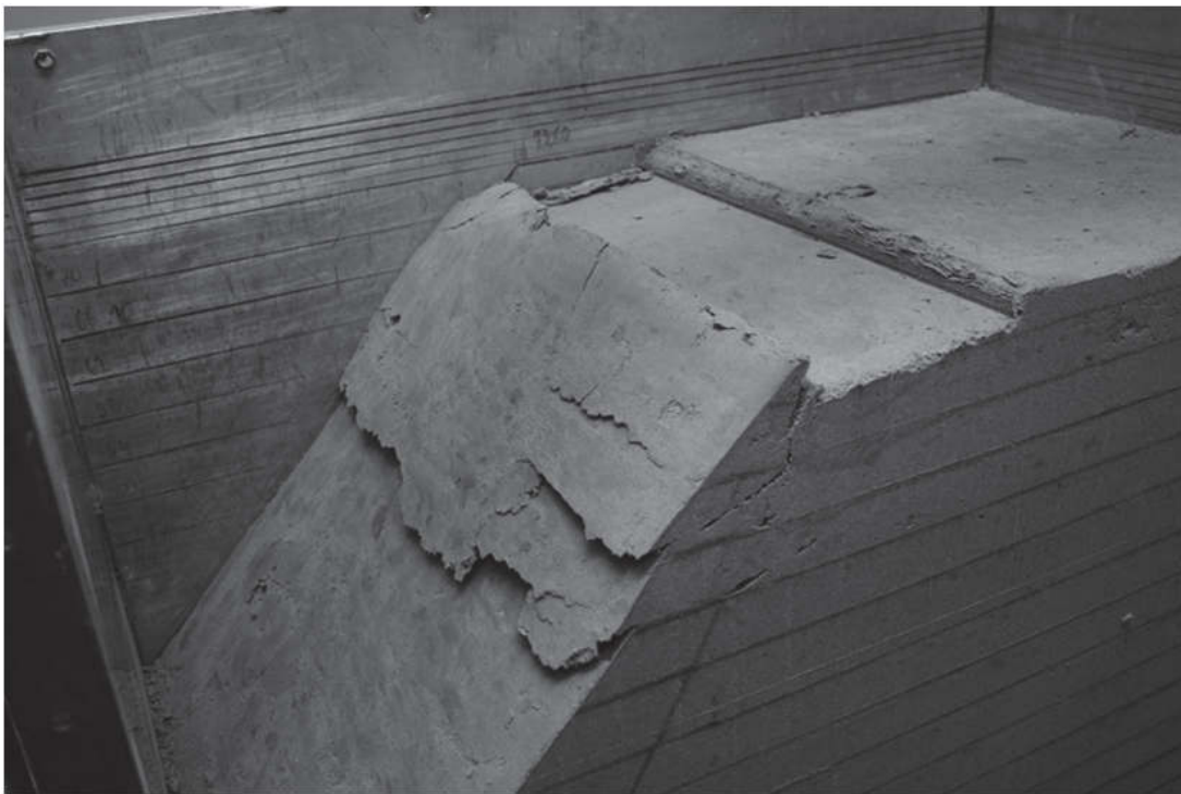
Rys. 7. Deformacje modelu nasypu z piasku pylastego na skutek utraty stateczności – skarpa o nachyleniu 45^\circ (fot. P. Baran)
