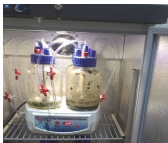
Rys. 2. Stanowisko badań – test BMP Fig. 2. The test bench – BMP
