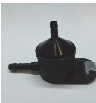
Rys. 2. Próbnik IOM z nasadką kalibracyjną Fig. 2. IOM sampler with calibration cap
