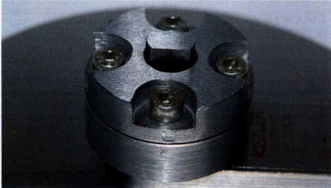
Rys. 5.18. Przyrząd do mocowania próbek w czasie eksperymentów
