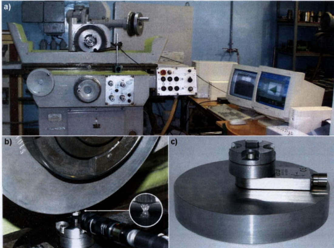
Rys. 5.2. Stanowisko obróbkowe: a) szlifierka do płaszczyzn SPC 20B firmy PONAR JOTES, b) kamera przemysłowa WV-KS152E firmy PANASONIC, c) piezoelektryczny siłomierz 9602AQ01 firmy KISTLER, wraz z zespołem wstępnego obciążenia i uchwytem próbek
