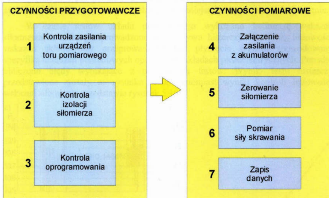
Rys. 5.8. Schemat procedury pomiaru siły
