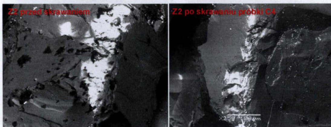
Rys. 6.60. Zużycie ziarna oznaczonego Z2 po skrawaniu próbki oznaczonej C4
