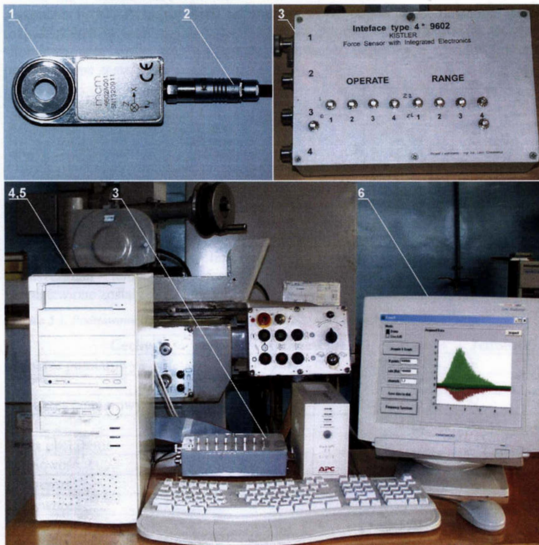
Rys. 5.4. Elementy toru pomiarowego siły skrawania
