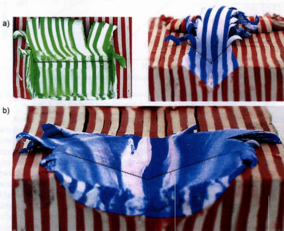
Rys. 2.46. Strefa mikroskrawania ostrzem o wierzchołku w kształcie: a) graniastosłupa 90^\circ , o odmiennej orientacji do kierunku skrawania, b) ostrosłupa 45^\circ [68]
