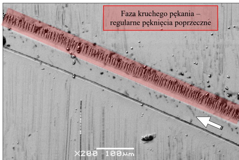
Rys. 5.75. Rysa 3 faza kruchego pęknięcia
