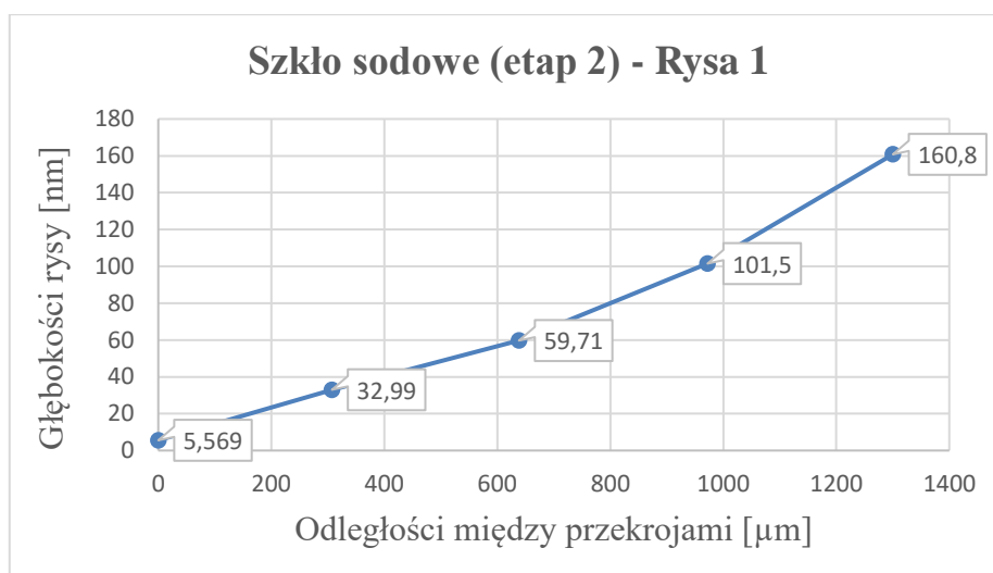
Rys. 5.38. Przykładowe wartości głębokości pojedynczej rysy wykonanej na szkłe sodowym (etap 2)
