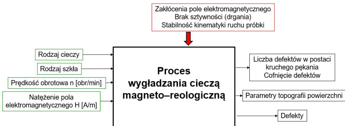
Rys. 5.7. Schemat badań mikro- i nanowygładzania przy wykorzystaniu cieczy magneto-reologicznej
