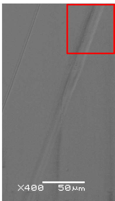
Rys. 5.80. Przebieg rysy w fazie plastycznego płynięcia materiału wraz z pojawiającymi się mikrowiórami
