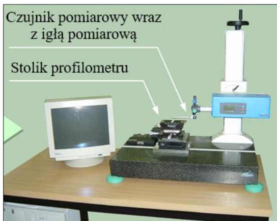
Rys. 5.119. Stanowisko badawcze wyposażone w profilometr Homelwerke 800 wraz z komputerem służącym do akwizycji danych wyposażonym w oprogramowanie MountainsLab
