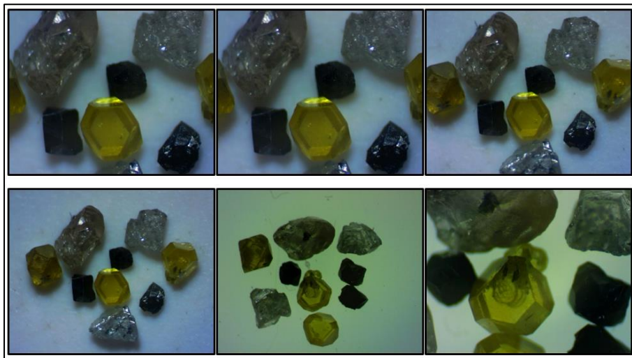
Rys. 5.17. Widok rzeczywisty ziaren skrawających (pow. \times 100 )
