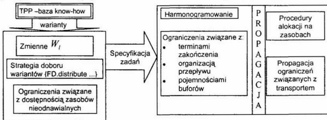
Rys. 3. Schemat systemu optymalizacji wyboru wariantu realizacji zlecenia
