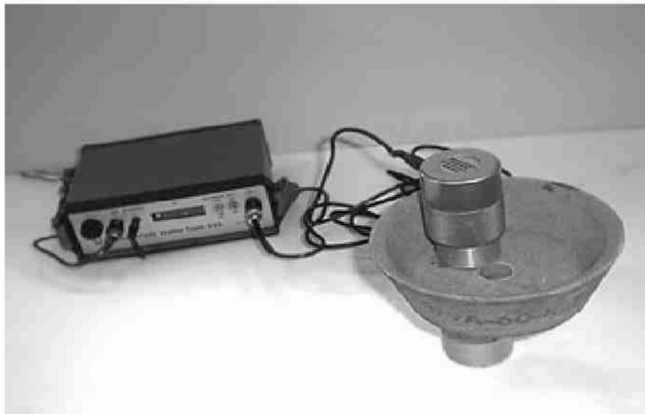
Rys. 60. Sposób diagnostyki ściernic kształtowych metodą ultradźwiękową Fig. 60. Methods of diagnosis for shaped grinding wheels by ultrasonic method
