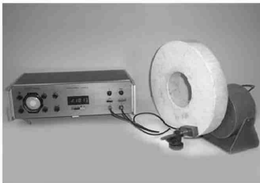
Rys. 51. Widok ogólny przyrządu do diagnostyki kontrolnej ściernic płaskich Fig. 51. General view of device for control diagnosis of flat grinding wheels
