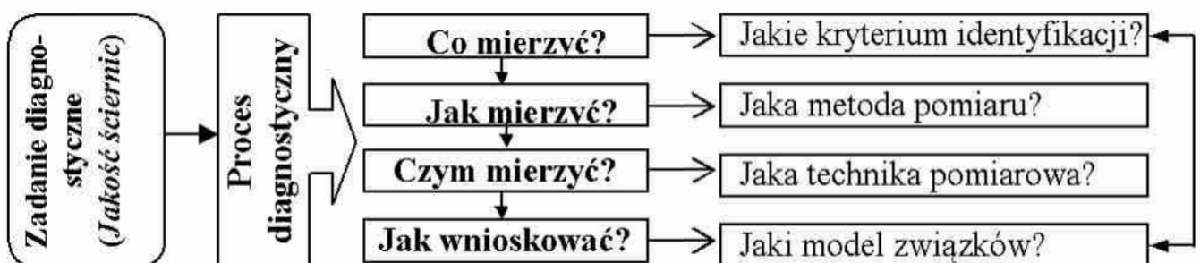
Rys. 35. Model systemowy procesu diagnostycznego narzędzi ściernych
