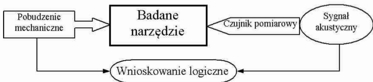
Rys. 43. Schemat ogólny badania akustycznego narzędzi ściernych
