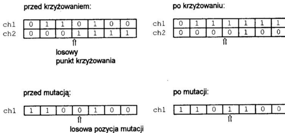
Rys.1. Przykład działania operatorów krzyżowania i mutacji Fig.1. Example of crossover and mutation
