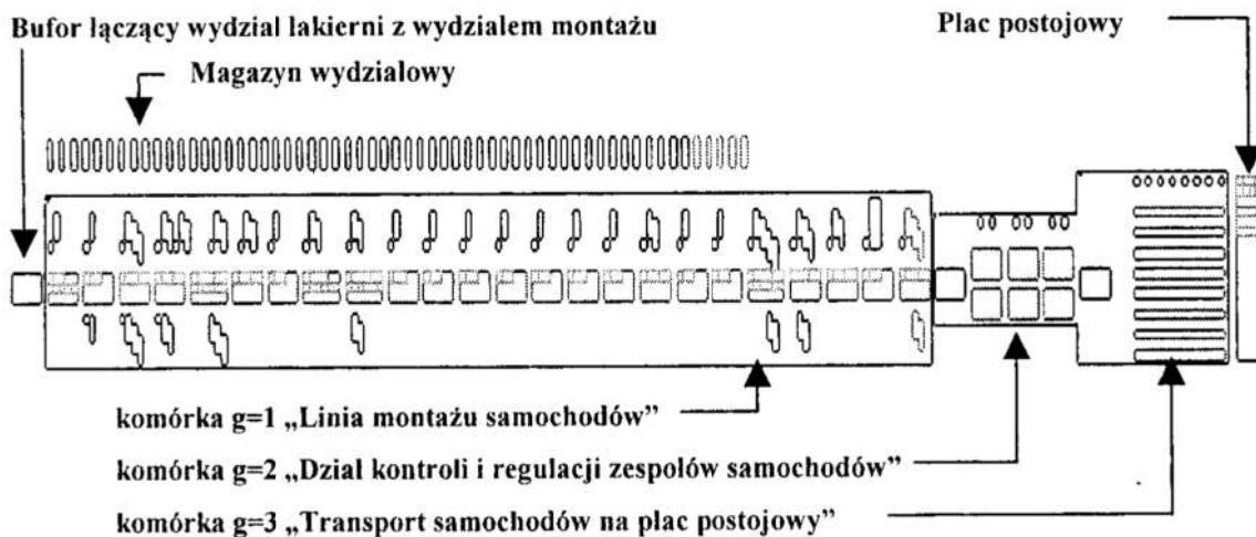
Rys. 1. Rozmieszczenie elementów modelu symulacyjnego Wydziału Montażu Samochodów w systemie Taylor II
