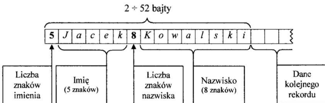
Rys. 2. Reprezentacja zapisu danych tekstowych na dysku Fig. 2. Representation of a text data on a hard disk
