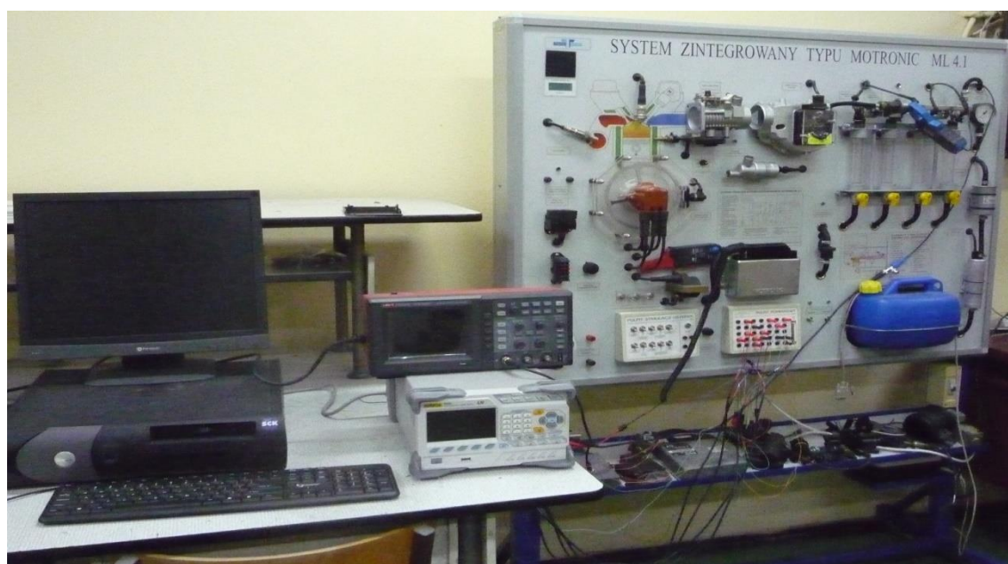
Rys. 5.2. Stanowisko badawcze benzynowego silnika o zapłonie iskrowym z systemem sterowania Motronic 4.1
