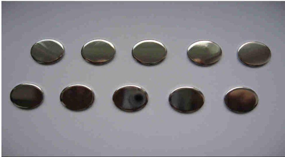
Rys. 5.15. Zestaw próbek ze stali kwasoodpornej 316L, \phi 18 mm (po polerowaniu), użyty do badań zasadniczych po: ECP – elektropolerowaniu (rząd dolny) oraz po MECP – magnetoelektropolerowaniu (rząd górny)
