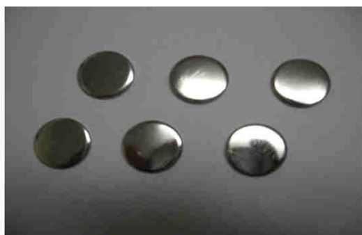
Rys. 5.11. Zestaw próbek ze stali kwasoodpornej 316L \phi 18 mm, użyty do badań wstępnych po: ECP – elektropolerowaniu (rząd dolny), oraz po MECP – magneto-elektropolerowaniu (rząd górny)
