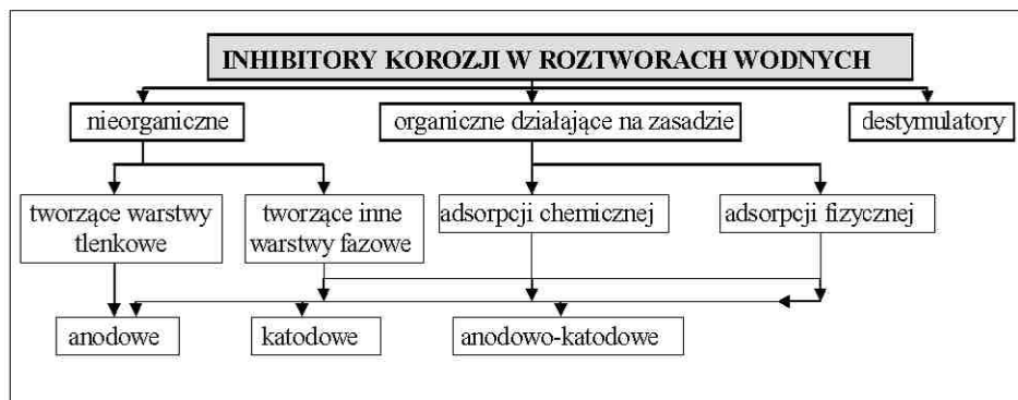
Rys. 8.57. Inhibitory korozji w roztworach wodnych, wg [213]
