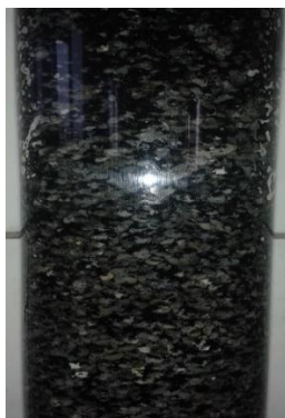
Fot. 6.4. Filtracja grawitacyjna w złożu o uziarnieniu f_z \in \langle 2,50 \div 3,15 \text{ mm} \rangle i frakcji fazy stałej kolmatanta (a) fk \in \langle 0,125 \div 0,20 \text{ mm} \rangle po wprowadzeniu V_n=130 dm 3 oraz (b) fk \in \langle 0,20 \div 0,25 \text{ mm} \rangle po wprowadzeniu V_n=130 dm 3
