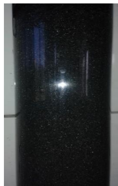
Fot. 6.1. Filtracja grawitacyjna w złożu o uziarnieniu f_z \in \langle 0,4 \div 0,5 \text{ mm} \rangle i frakcji fazy stałej kolmatanta (a) f_k \in \langle 0 \div 0,04 \text{ mm} \rangle po wprowadzeniu V_n = 19 \text{ dm}^3 oraz (b) f_k \in \langle 0,04 \div 0,063 \text{ mm} \rangle po wprowadzeniu V_n = 15 \text{ dm}^3
