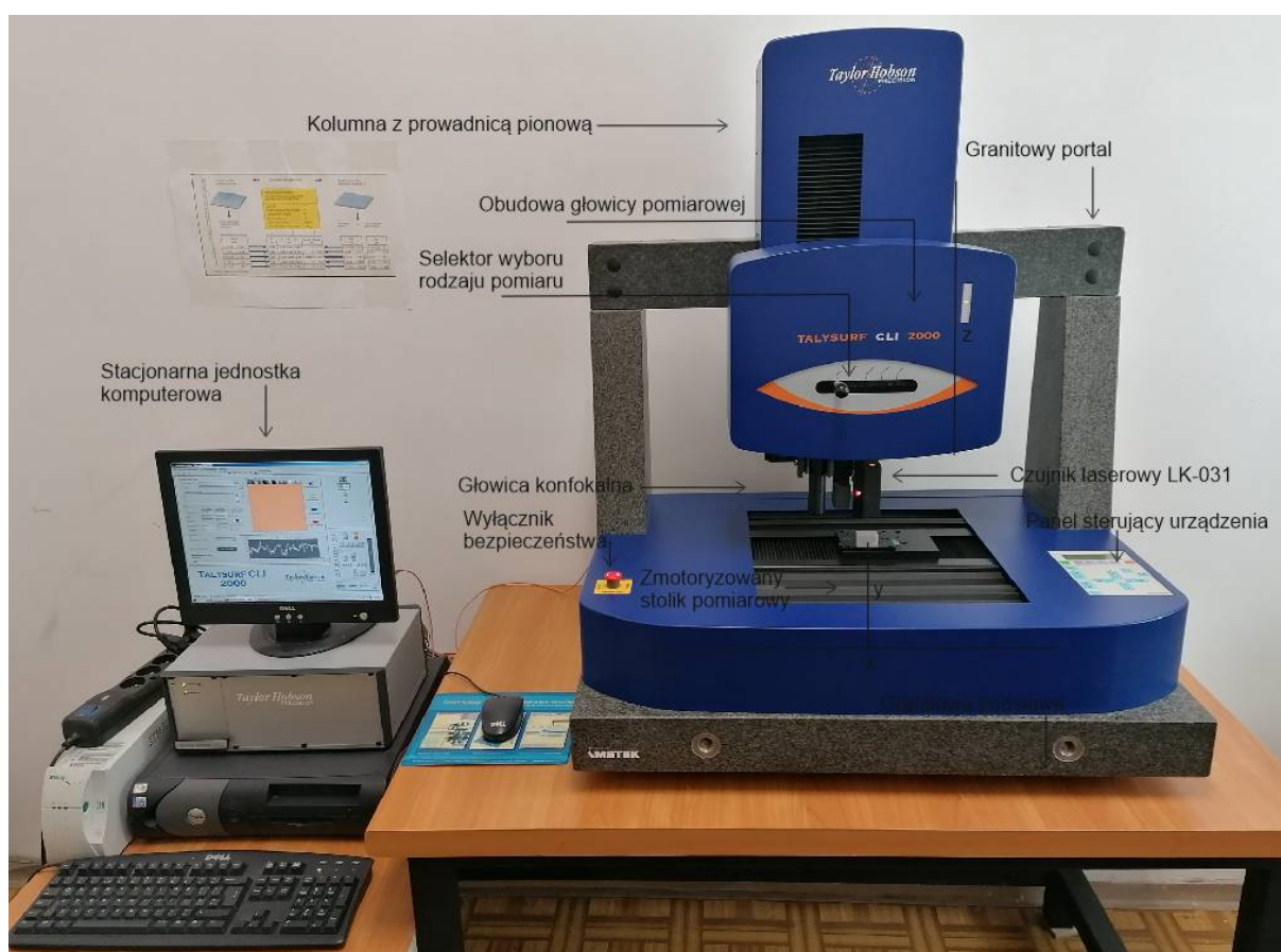
Rys. 48. Stanowisko pomiarowe wyposażone w wielogłowicowy system pomiarowy Talysurf CLI 2000 firmy Taylor-Hobson Ltd.
