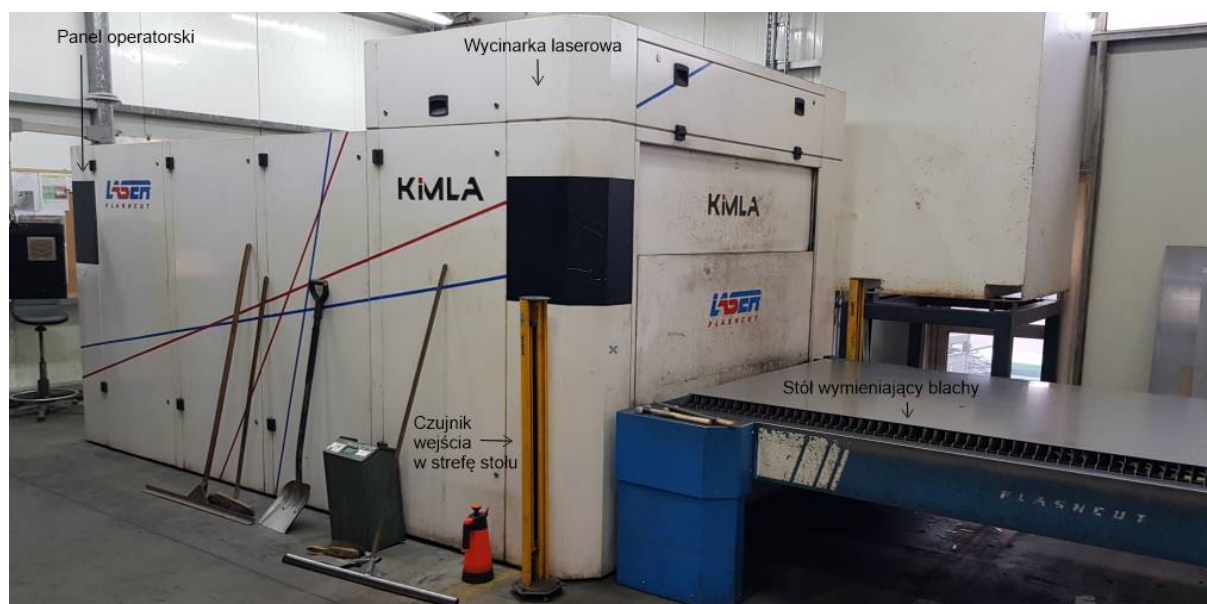
Rys. 43. Widok stanowiska badawczego wyposażonego w urządzenie do wycinania strumieniem fotonów Kimla FlashCUT LF 1530 6 kW
