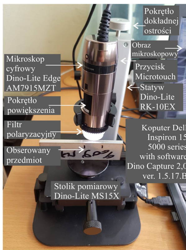
Rys. 50. Elementy składowe stanowiska do rejestracji obrazów czynnej powierzchni oraz powierzchni obrobionej metodą mikroskopii opto-cyfrowej wyposażonego w cyfrowy mikroskop pomiarowy Dino-Lite Edge AM7915MZT firmy ANMO Electronics Co.
