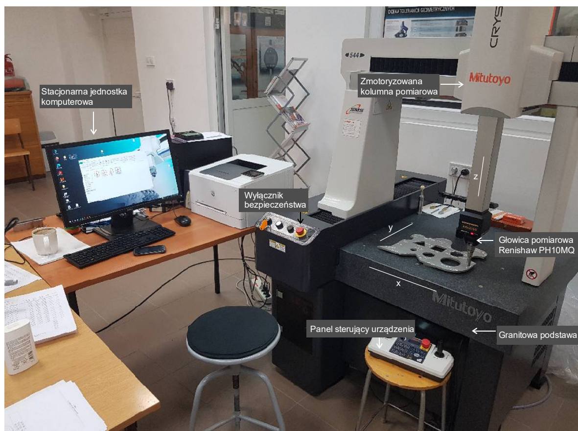
Rys. 52. Elementy składowe stanowiska do pomiarów współrzędnościowych wyposażonego w zautomatyzowaną maszynę pomiarową Mitutoyo CRYSTA – WMP CNC serii Apex V 544
