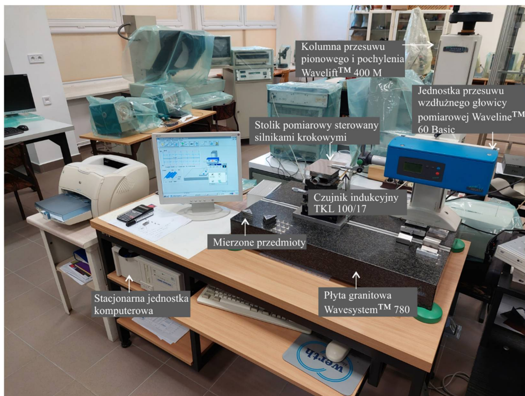
Rys. 54. Stanowisko do pomiaru mikrotopografii powierzchni przedmiotów obrobionych metodą stykową wyposażone w profilometr Hommel-Tester T8000 firmy Hommelwerke GmbH
