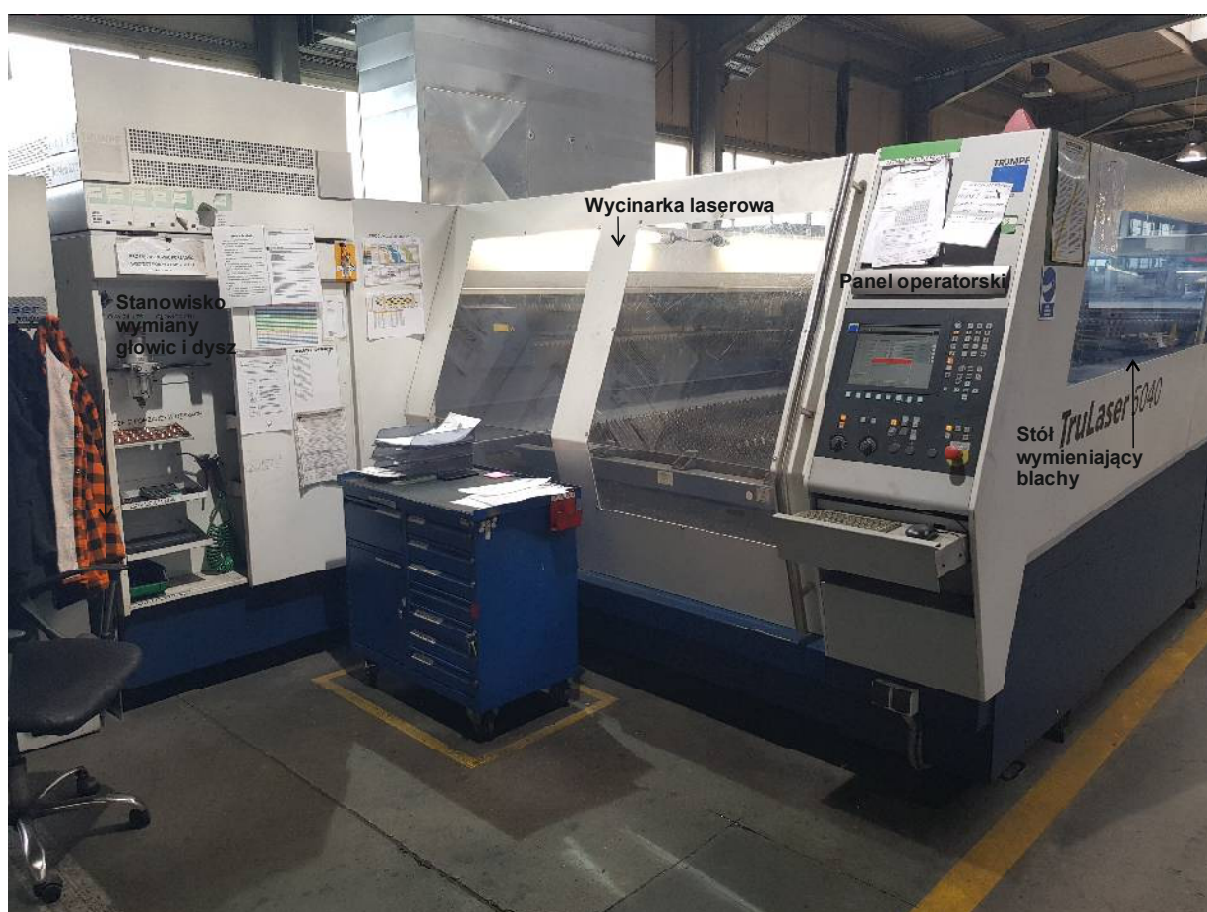
Rys. 44. Widok stanowiska badawczego wyposażonego w urządzenie do wycinania strumieniem fotonów TRUMPF CO 2 serii TruFlow 6000 6 kW
