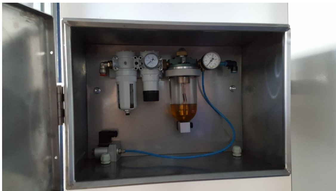
Rys. 60. System smarowania typu UDL-5 EP produkcji FŁT Kraśnik SA: a) schemat systemu (www.flt24.pl, 2020); b) widok systemu zamontowanego w stanowisku badawczym
