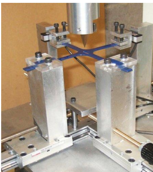
Rys. 20. Stanowisko do pomiaru stosunku naprężenia rzeczywistego do rozciągania w kierunku wzdłużnym i poprzecznym na próbce modelowej imitującej skórę – poliuretanie o twardości 40A wg Shore'a (Gilchrist i inni, 2007; Gilchrist i inni, 2008)
