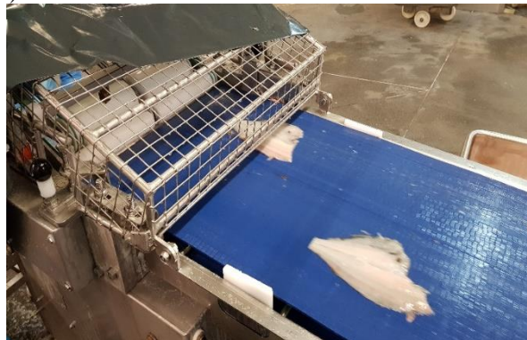
Rys. 1. Linia do skórowania ryb płaskich w przedsiębiorstwie Espersen Poland Sp. z o.o. (Koszalin, Polska): a) widok ogólny linii technologicznej; b) maszyna skórująca ST600 firmy Steen F.P.M. International (Kalmthout, Belgia); c) obszar roboczy w procesie skórowania (Zieliński i Nadolny, 2019; Zieliński i inni, 2020; Gibson i inni, 2014)
