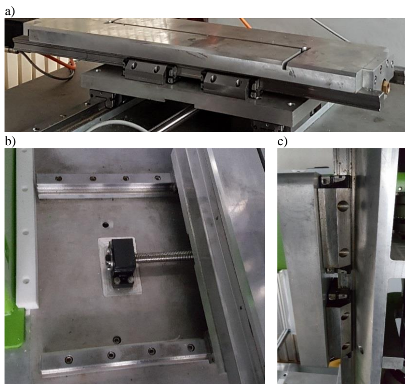
Rys. 62. Układ prowadnic i wózków zamontowanych w specjalnej szlifierce CNC do kształtowania ostrzy technicznych: a) dla osi X; b) dla osi Y; c) dla osi Z
