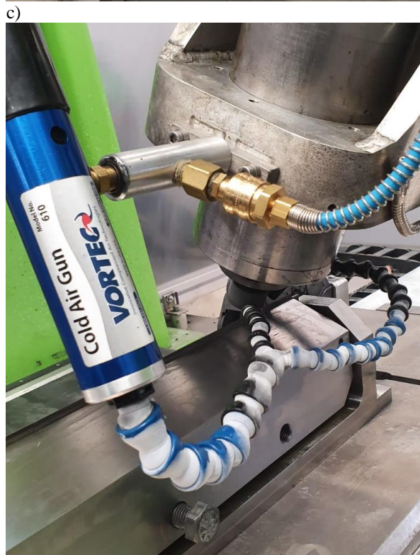
Rys. 99. Widok strefy szlifowania w konfiguracji umożliwiającej zastosowanie: a) metody zalewowej (WET); b) smarowania ze zminimalizowanym wydatkiem (MQL); c) chłodzenia z użyciem schłodzonego sprężonego powietrza (CAG); d) metody hybrydowej polegającej na jednoczesnym zastosowaniu dyszy MQL i CAG (MQL+CAG)
