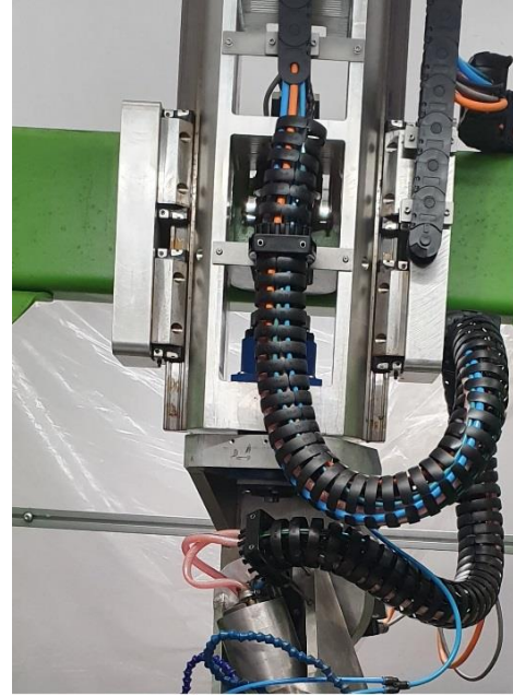
Rys. 57. Korpus pomocniczy osi C: a) widok aksonometryczny modelu CAD 3D; b) widok ogólny wykonanego korpusu z zamontowanymi podzespołami
