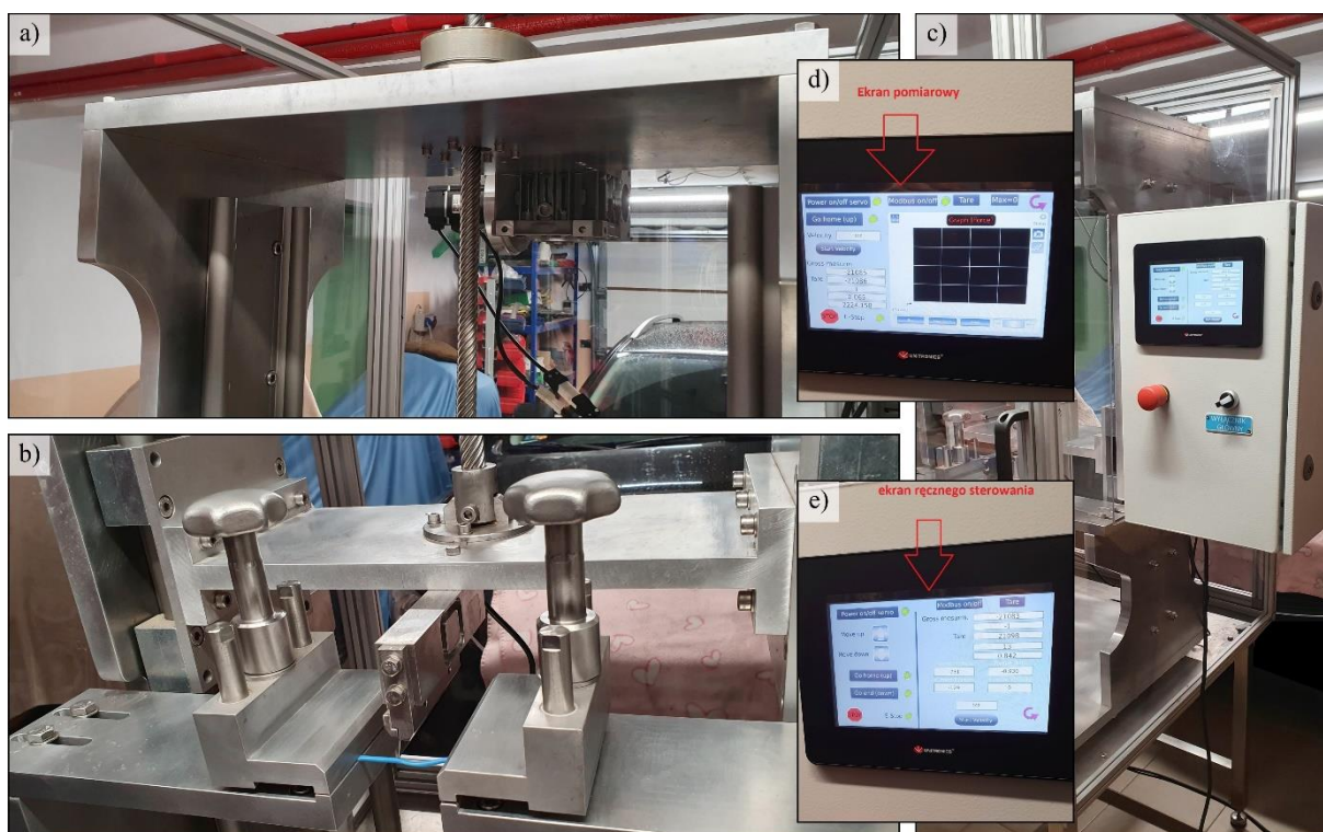
Rys. 77. Widok szczegółów konstrukcyjnych wykonanego stanowiska do określenia ostrości ostrza technicznego (w trakcie prac kalibracyjnych): a) widok górnego mocowania śruby napędowej i jej napędu; b) widok uchwytu noża technicznego oraz szczęk mocujących przecinaną próbkę; c) widok szafy sterowniczej; d) widok ekranu pomiarowego; e) widok ekranu manualnego sterowania pracą urządzenia
