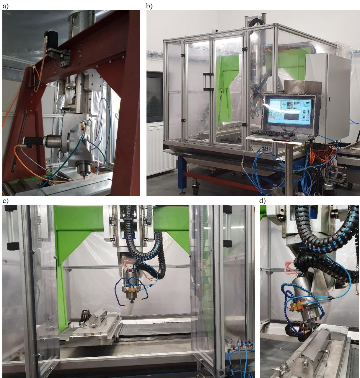
Rys. 50. Specjalna pięcioosiowa szlifierka CNC do kształtowania ostrzy noży technicznych: a) widok szlifierki w trakcie budowy; b) widok urządzenia gotowego do pracy; c) widok strefy obróbki; d) widok elektrowrzeciona szlifierskiego wraz z uchwytem przedmiotu obrabianego oraz systemem podawania chłodziwa (Zieliński i inni, 2018; Zieliński i inni, 2019; Zieliński i inni, 2019a)
