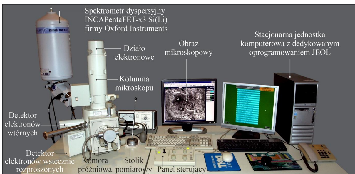
Rys. 49. Rys. B.8. Elektronowy mikroskop skaningowy JSM-5500LV firmy JEOL Ltd. wyposażony w moduł energodispersyjnego spektrometru rentgenowskiego (EDS) INCAPentaFET-x3 firmy Oxford Instruments (Kaplonek i Nadolny, 2013; Kaplonek i Nadolny, 2013a; Nadolny i Kaplonek 2015; Nadolny i inni, 2017)
