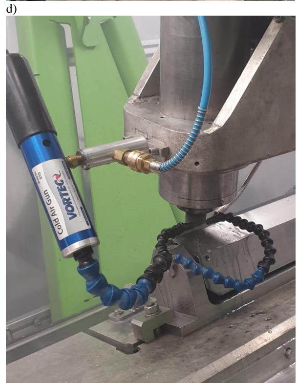
Rys. 99. Widok strefy szlifowania w konfiguracji umożliwiającej zastosowanie: a) metody zalewowej (WET); b) smarowania ze zminimalizowanym wydatkiem (MQL); c) chłodzenia z użyciem schłodzonego sprężonego powietrza (CAG); d) metody hybrydowej polegającej na jednoczesnym zastosowaniu dyszy MQL i CAG (MQL+CAG)
