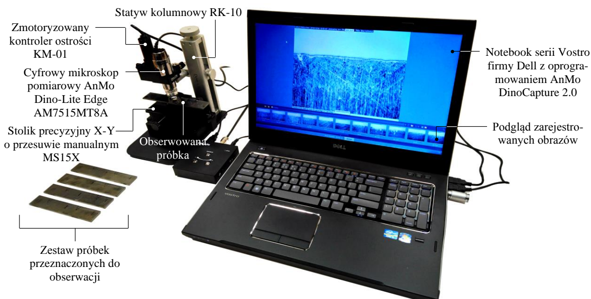
Rys. 48. Ogólny widok stanowiska do akwizycji obrazów cyfrowych wyposażonego w cyfrowy mikroskop pomiarowy Dino-Lite Edge AM7515MT8A firmy AnMo Electronics Corp. (Nadolny i inni, 2020; Nadolny i inni, 2021; Nadolny i inni, 2021a; Nadolny i inni, 2022)
