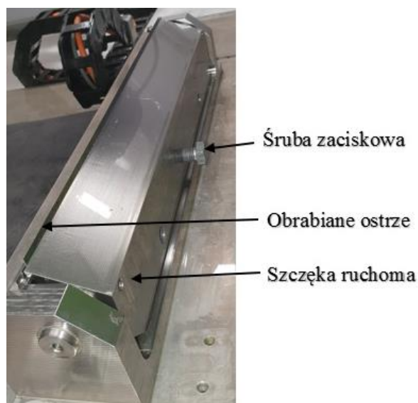
Rys. 35. Widok specjalnego uchwytu (wraz z zamocowanym ostrzem) opracowanego w celu unieruchomienia wiotkiego ostrza planarnego w przestrzeni roboczej szlifierki
