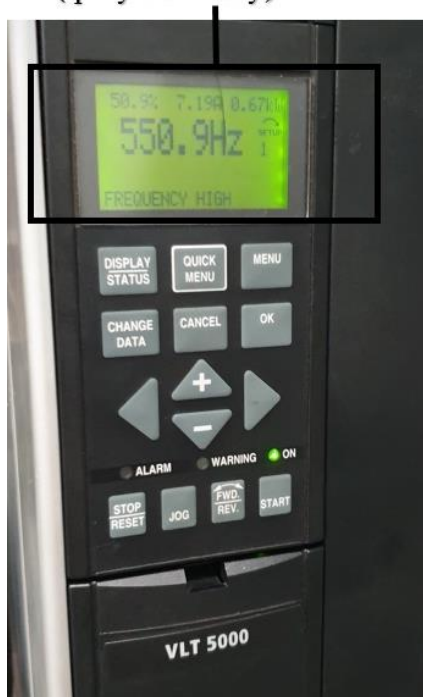
Rys. 32. Widok ogólny przemiennika częstotliwości Danfoss VLT 500 oraz parametrów pracy wrzeciona szlifierskiego w czasie rzeczywistym
