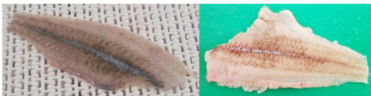
Rys. 43. Widok fileta rybnego po prawidłowo przeprowadzonym procesie skórowania
