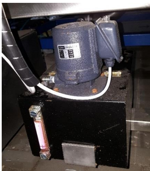
Rys. 61. Układ typu EP-18-150K do chłodzenia elektrowrzeciona szlifierskiego
