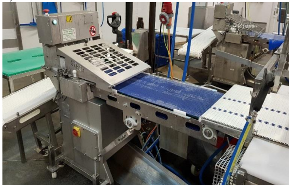
Rys. 1. Linia do skórowania ryb płaskich w przedsiębiorstwie Espersen Poland Sp. z o.o. (Koszalin, Polska): a) widok ogólny linii technologicznej; b) maszyna skórująca ST600 firmy Steen F.P.M. International (Kalmthout, Belgia); c) obszar roboczy w procesie skórowania (Zieliński i Nadolny, 2019; Zieliński i inni, 2020; Gibson i inni, 2014)
