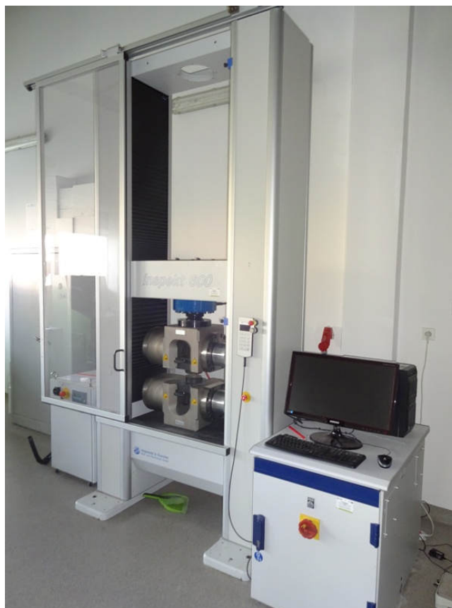
Rys. 3.1. Maszyna wytrzymałościowa Inspekt 600 firmy Hegewald&Peschke Meß- Und Prüftechnik GmbH
