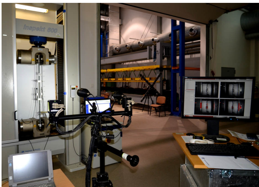
Rys. 3.17. System optycznej koleracji obrazu Aramis
