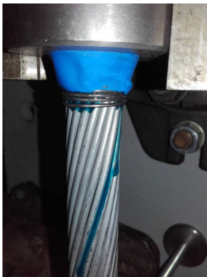
Rys. 3.11. Wyciek żywicy na skutek niepoprawnego zabezpieczenia
