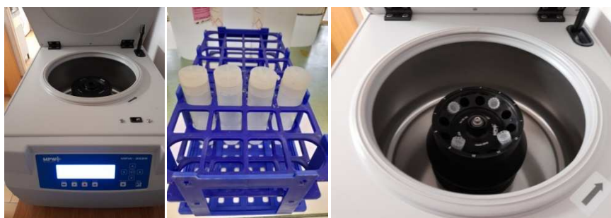
Rys. 3. Wirówka laboratoryjna MPW wraz ze stojakiem na próbki wirownicze – sposób umieszczenia probówek wirowniczych w rotorze wirówki
