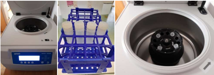
Rys. 8. Wirówka laboratoryjna MPW wraz ze stojakiem na próbki wirownicze – sposób umieszczenia próbek wirowniczych w rotorze wirówki
