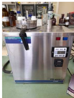
Rys. 18. Urządzenie Ankom do pomiarów zawartości włókna wraz z tacami, na których umieszcza się woreczki filtracyjne
