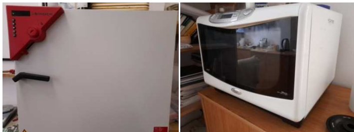
Rys. 25. Suszarka laboratoryjna i kuchnia mikrofalowa do obróbki termicznej olejów
