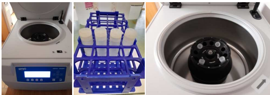
Rys. 21. Wirówka laboratoryjna MPW wraz ze stojakiem na próbki wirownicze – sposób umieszczenia próbek wirowniczych w rotorze wirówki
