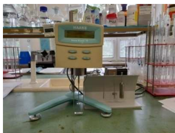
Rys. 28. Aparat Visco-Tester VT7 wraz z wrzecionami do pomiarów lepkości roztworów
