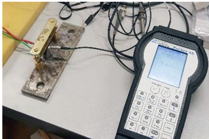
Rys. 5.20. Analizator przenośny PocetAE2 w trakcie pomiarów sygnału emisji akustycznej
