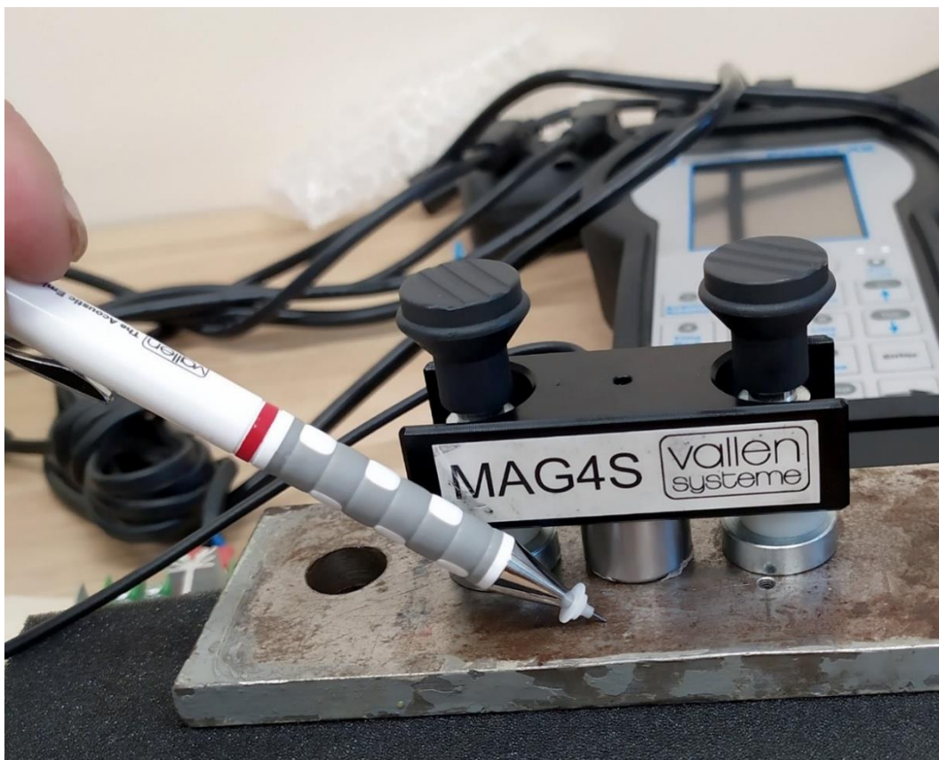
Rys. 2.12. Badanie sygnałów wygenerowanych za pomocą testu łamania ołówka
