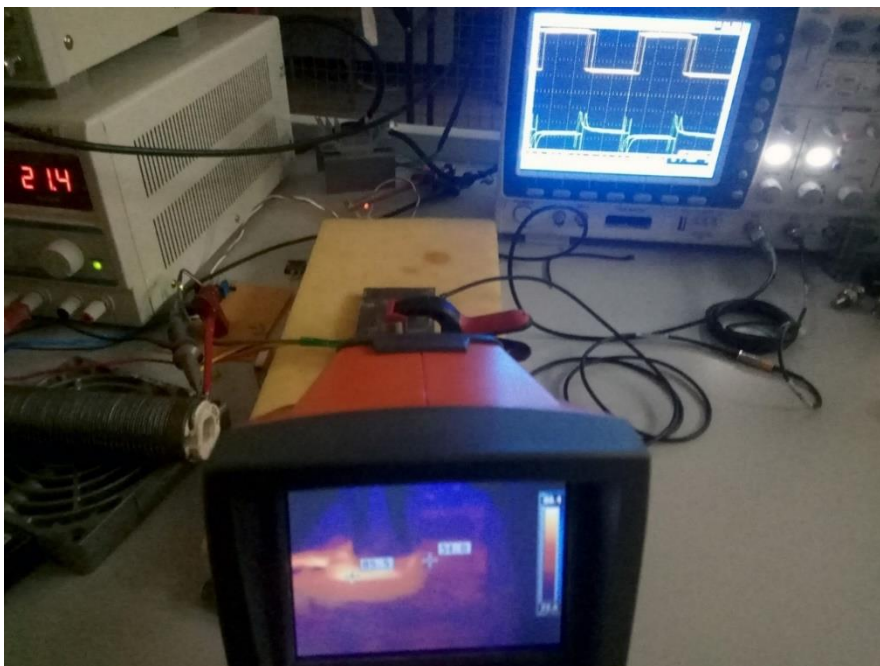
Rys. 5.23. Pomiar Kamera termowizyjną
