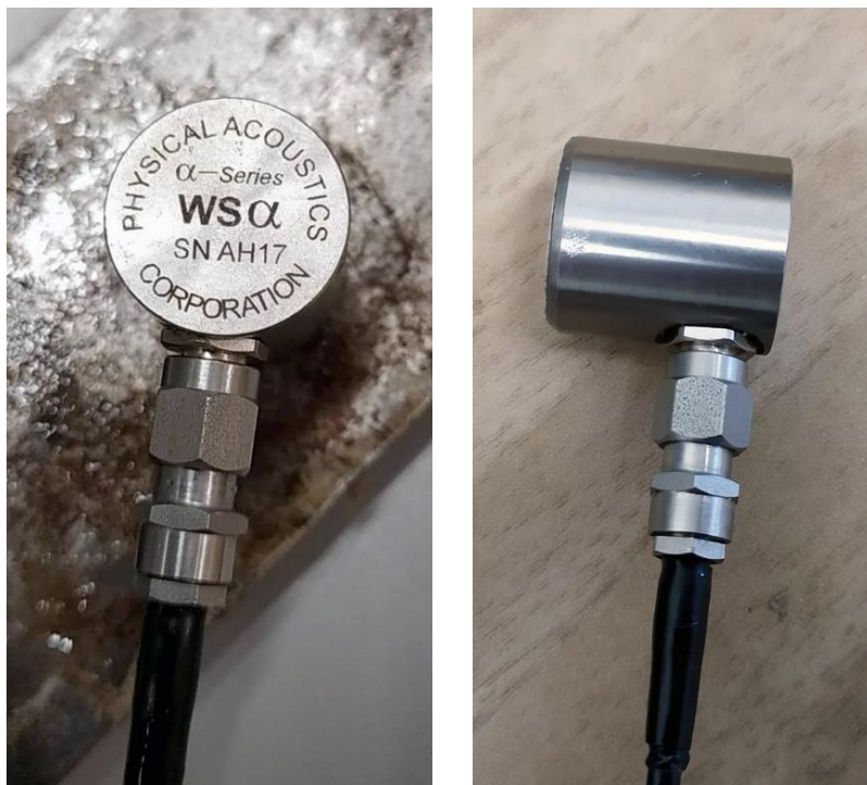
Rys. 2.10. Sensor emisji akustycznej typu WS Alpha firmy Physical Acoustics
