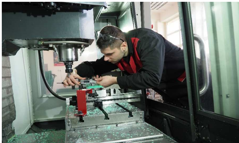
Widok strefy roboczej 3-osiowego centrum frezerskiego HAAS VF-2 będącego na wyposażeniu Centrum Edukacji Technicznej HAAS
