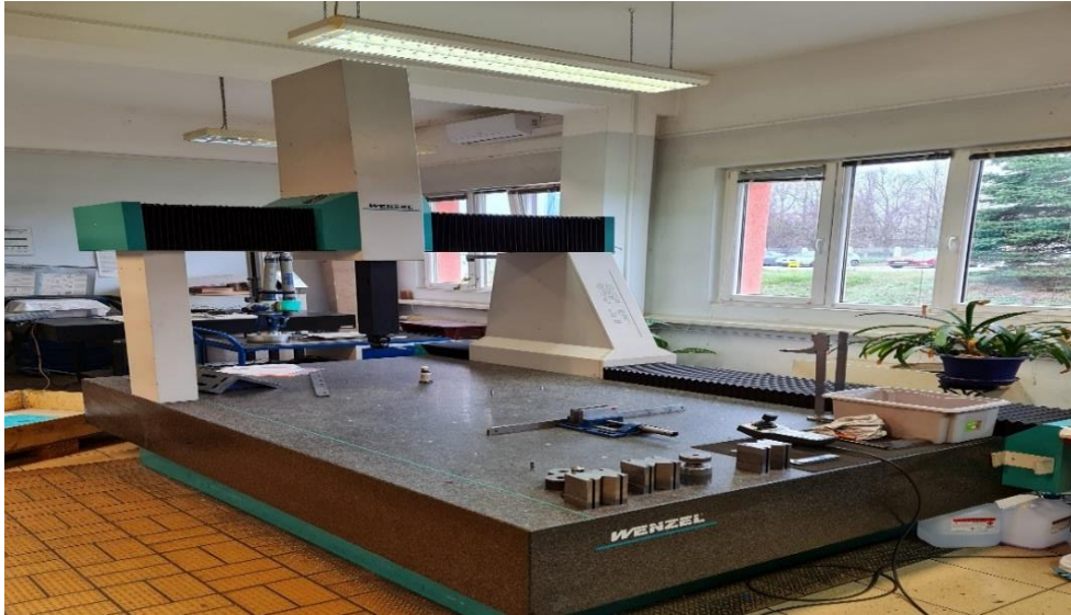
Rys. 14. Stanowisko pomiarowe Wenzel LH 108 w firmie TEPRO S.A.
