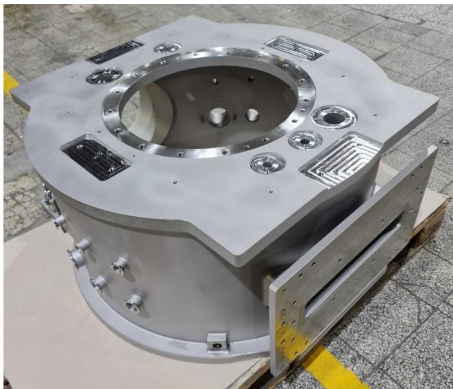
Rys. 8. Przykładowa komora próżniowa ze stali 1.4301 wykonana w TEPRO S.A.
