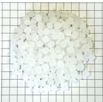
Rys. 23. Granulat polietylenu małej gęstości Malen E FGNX 23-D022 Basell Orlen Polyolefins
