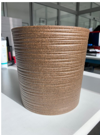
Rys. 18. Donica wykonana z kompozytu polimerowego z dodatkiem łuski kawowej [177]
