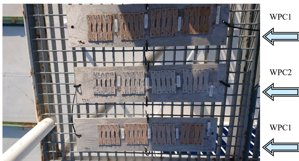
Rys. 63. Widok próbek umieszczonych na promie pasażerskim po 180 dniach oddziaływania warunków panujących na Bałtyku
