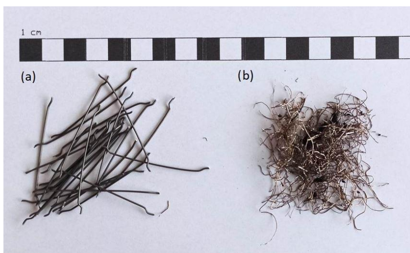
Rys 4.3. Włókna wykorzystane do badanych kompozytów a) haczykowane włókna stalowe 50/0.8 b) kord stalowy [68]
