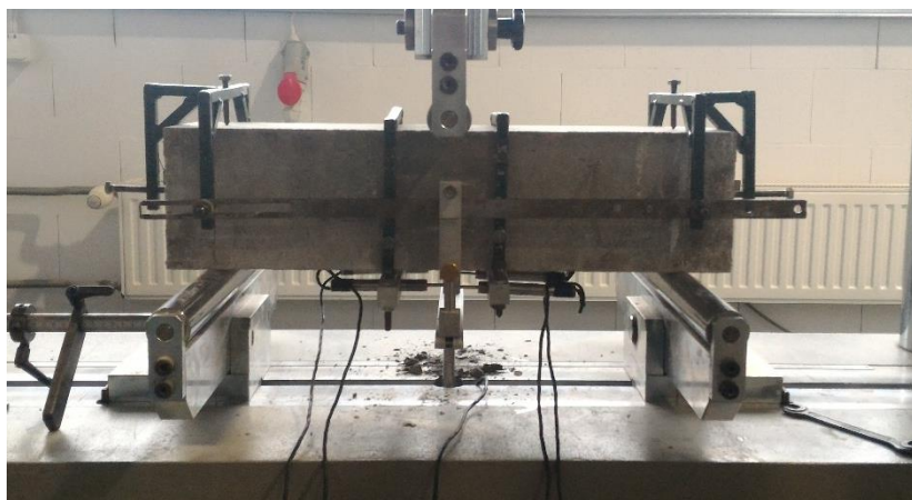
Rys 5.3. Badanie wytrzymałości resztkowych na prasie wytrzymałościowej Walter+Bai DB200 z zamocowanymi czujnikami do pomiaru szerokości rozwarcia rysy
