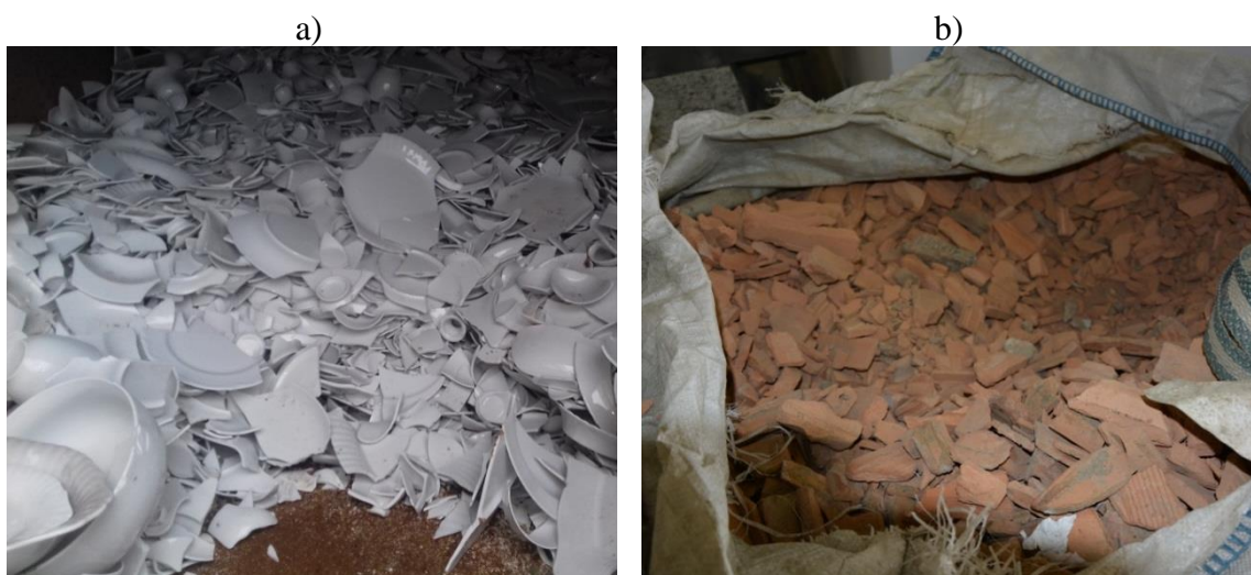
Rys 4.1. Odpady fabryczne wykorzystane do wytworzenia kruszywa: a) odpady z fabryki porcelany, b) odpady z fabryki pustaków ceramicznych po wstępnym kruszeniu
