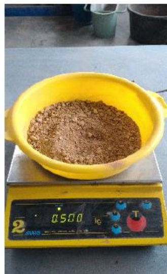
Rys 5.1. Badanie gęstości pozornej kruszywa uzyskanego w procesie kruszenia odpadów z produkcji pustaków ceramicznych
