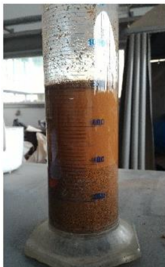
Rys 5.1. Badanie gęstości pozornej kruszywa uzyskanego w procesie kruszenia odpadów z produkcji pustaków ceramicznych
