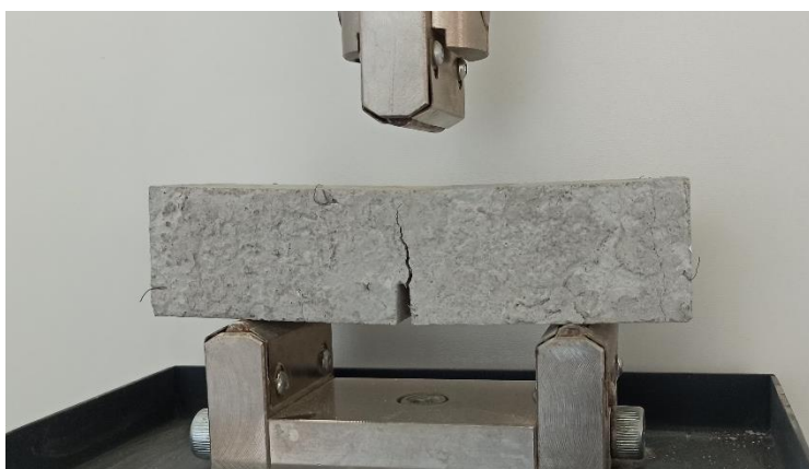
Rys 6.4. Próbką z nacięciem 4 mm po zakończonym teście trypunktowego zginania.
