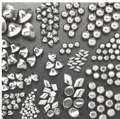
Rys. 22 Kształty stalowych kształtek polerskich [21]
