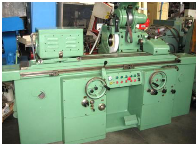
Rys. 103 Uniwersalna szlifierka do wałków i otworów JOTES SWA-25
