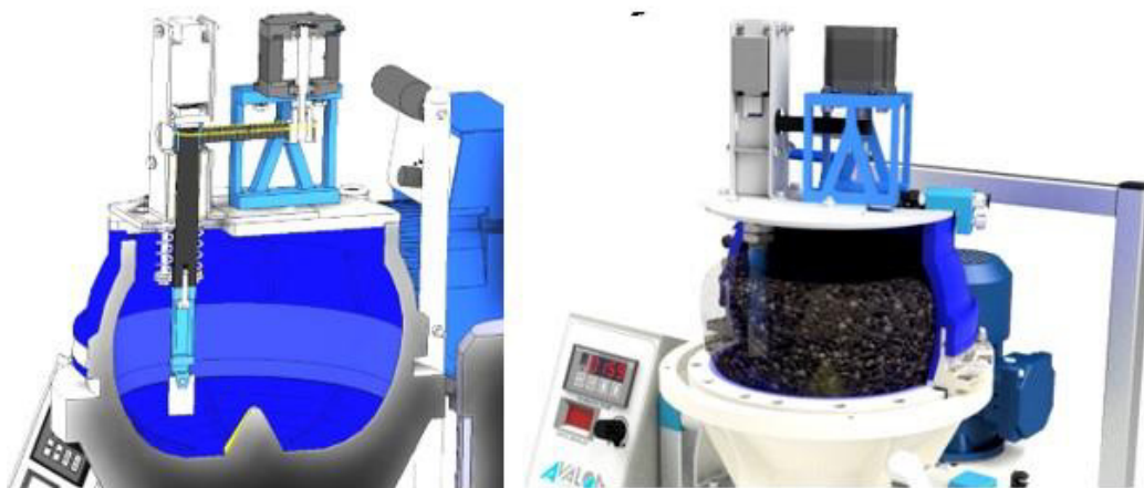
Rys.53. Animacja pracy systemu obróbkowego na wyładowarce EC6: a) model 3D układu roboczego, b) symulacja ruchów wsadu roboczego i uchwytu przedmiotowego
