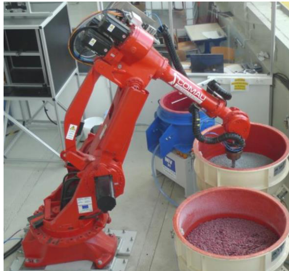
Rys.36. Realizacja procesu obróbki w wygładzarce strumieniowej z zastosowaniem robota przemysłowego pełniącego funkcję uchwytu przedmiotowego [54]
