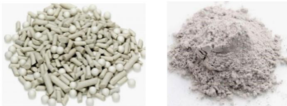
Rys. 109. Porcelanowe kształtki polerskie CMG a) i proszek ścierny GP20
