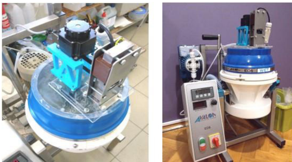
Rys. 52. Widok aktywnego uchwytu przedmiotowego po zamontowaniu na wygładzarce EC6 a i widok kompletnego stanowiska badawczego b)
