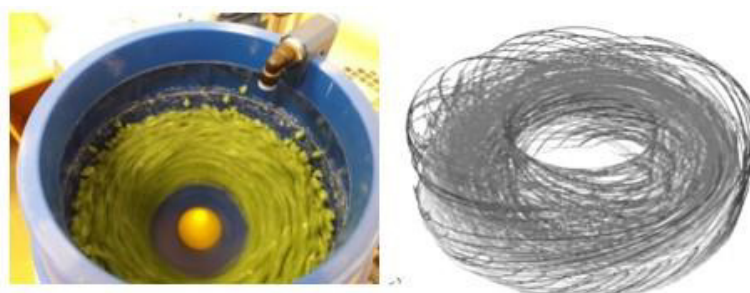
Rys.5. Wirujący strumień kształtek w komorze roboczej rotacyjno-kaskadowej wygładzarki pojemnikowej: a) widok ogólny, b) tory ruchu kształtek (opracowanie własne)
