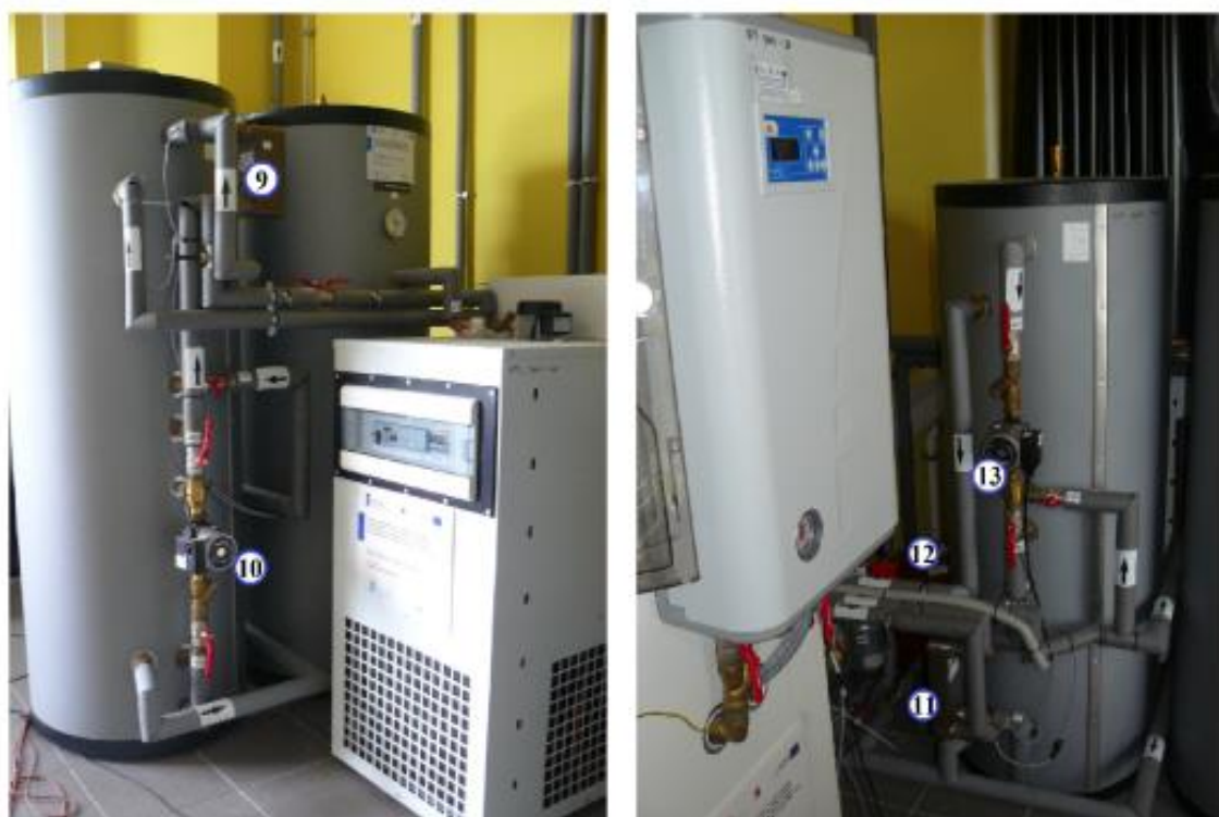
Rys. 3.13. Stanowisko badawcze: 1 - stanowisko komputerowe, 2 - elektromagnetyczne przepływomierze z zaworami regulacyjnymi, 3 - skrzynka zasilania elektrycznego stanowiska badawczego, 4 - hydrauliczna pompa obiegowa, 5 - kocioł grzewczy, 6 - układ akwizycji zebranych danych pomiarowych, 7 - dwa zasobniki wodne, 8 - chłodziarka, 9 - wymiennik ciepła obiegu chłodzącego, 10 - pompa obiegu chłodzącego, 11 - wymiennik obiegu grzewczego, 12 - naczynie wzbiornicze, 13 - pompa obiegu grzewczego [83]
