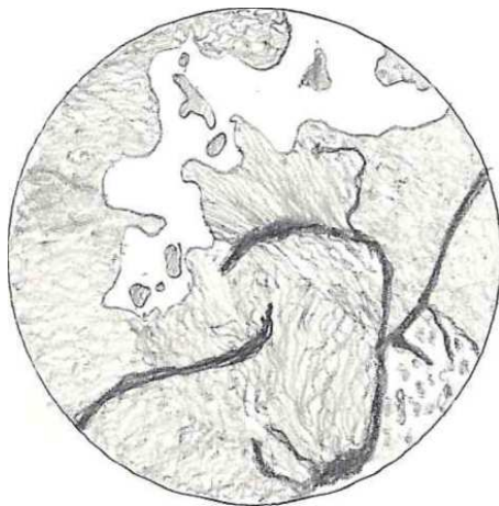
Rys. 7.9. Żeliwo pstre. Struktura: osnowa metaliczna perlitu z jasnymi obszarami ledeburytu przemienionego, ciemne wydzielenia grafitu płatkowego. Zgład trawiony: 4% NITAL (4% \text{HNO}_3 w \text{C}_2\text{H}_5\text{OH} ). Powiększenie mikroskopowe \times 400
