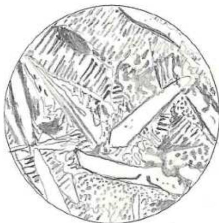
Rys. 6.16. Stop nadeutektyczny o zawartości węgla ok. 5%. Struktura: drobnoziarnista mieszanina eutektyczna ledeburytu przemienionego oraz jasne podłużne wydzielenia cementytu pierwotnego. Zgład trawiony: 4% NITAL (4% \text{HNO}_3 w \text{C}_2\text{H}_5\text{OH} ). Powiększenie mikroskopowe \times 100
