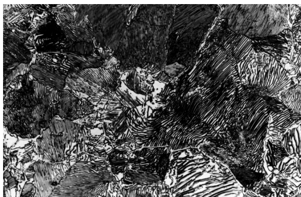
Rys. 6.7. Struktura perlitu (trawiona NITAL 4%, pow. mikroskopowe \times 400 )
