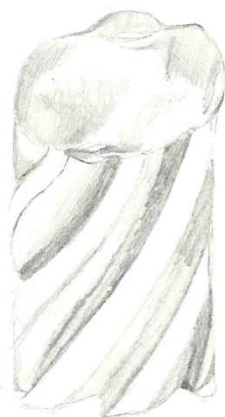
Rys. 1.6. Szkic freza palcowego wykonanego ze stali narzędziowej szybko tnącej. Droбноziarnista struktura i gładka powierzchnia przełomu świadczy o prawidłowo przeprowadzonej obróbce cieplnej
