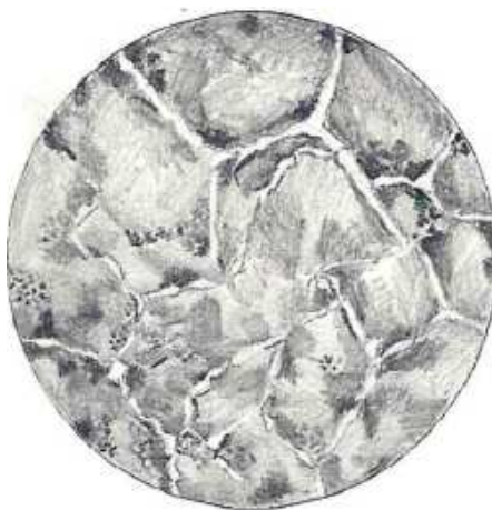
Rys. 6.11. Stop podutektoidalny o zawartości węgla ok. 0,7%. Struktura perlityczna na granicach ziaren siatka jasnego ferrytu oraz wtrącenia niemetaliczne. Zgład trawiony: 4% NITAL (4% \text{HNO}_3 w \text{C}_2\text{H}_5\text{OH} ). Powiększenie mikroskopowe \times 400
