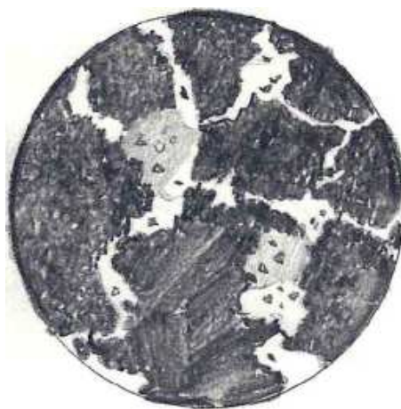
Rys. 10.9. Stal 50HS (znak wg PN-H-84032:1974) stopowa konstrukcyjna sprężynowa, resorowa – po wyżarzaniu normalizującym. Struktura: perlit stopowy i ferryt stopowy. Zgląd trawiony: 4% NITAL (4% \text{HNO}_3 w \text{C}_2\text{H}_5\text{OH} ). Powiększenie mikroskopowe \times 500
