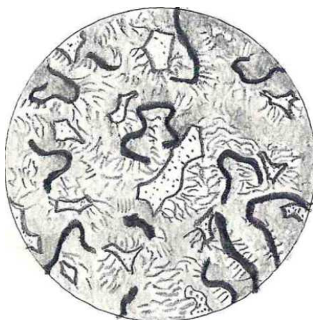
Rys. 7.10. Szare zwykłe EN-GJL-250. Struktura z osnową metaliczną perlityczną z jasnymi obszarami eutektyki fosforowej (steadyt), wydzielienia grafitu płatkowego. Zgład trawiony: 4% NITAL (4% \text{HNO}_3 w \text{C}_2\text{H}_5\text{OH} ). Powiększenie mikroskopowe \times 400
