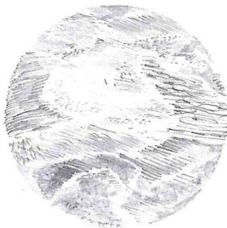
Rys. 8.9. Stal niestopowa narzędziowa C80U. Struktura perlityczna. Zgład trawiony: 4% NITAL (4% \text{HNO}_3 w \text{C}_2\text{H}_5\text{OH} ). Powiększenie mikroskopowe \times 400
