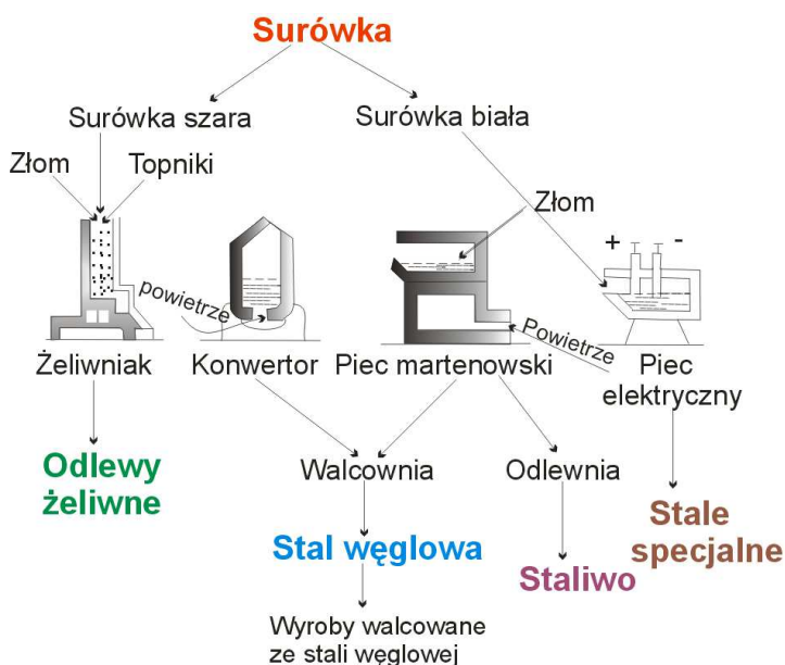
Rys. 8.1. Wytwarzanie stali i innych stopów żelaza z węglem [Blic-17-1]
