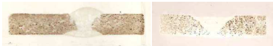
Rys. 1.1. Spoina doczołowa: a) typu X, b) typu Y. Niejednorodność składu chemicznego w złączach spawanych określona w próbie Baumanna. Widoczne zaciemnienie papieru fotograficznego w miejscach występowania siarczków
