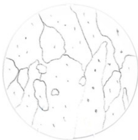
Rys. 10.15. Stop na osnowie kobaltu Co-Cr-Mo – na implanty medyczne. Struktura: osnowa ziarna fazy β-Co oraz wydzielienia węglików. Zgład trawiony: roztwór 3ml HCl + 1ml HNO 3 . Powiększenie mikroskopowe ×500
