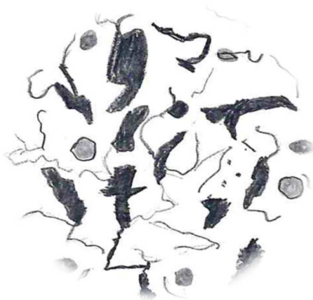
Rys. 8.6. Stal niestopowa konstrukcyjna S185. Struktura ferrytyczno-perlityczna oraz wtrącenia niemetaliczne. Zgład trawiony: 4% NITAL (4% \text{HNO}_3 w \text{C}_2\text{H}_5\text{OH} ). Powiększenie mikroskopowe \times 400
