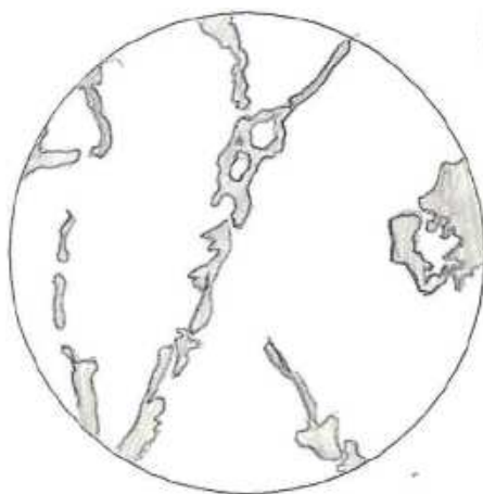
Rys. 13.4. Silumin EN AC-ALSi10 w stanie lanym, niemodyfikowany. Struktura: gruboziarnista eutektyka ( \alpha + \text{Si} ). Zgląd trawiony: roztwór 0,5ml HF w 99,5ml \text{H}_2\text{O} . Powiększenie mikroskopowe \times 500
