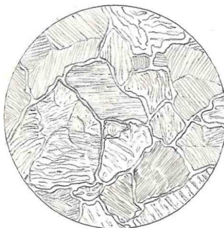
Rys. 6.13. Stop nadeutektoidalny o zawartości węgla ok. 1,0%. Struktura perlityczna z wydzieleniami cementytu wtórnego na graniach ziaren oraz wtrącenia niemetaliczne. Zgład trawiony: 4% NITAL (4% \text{HNO}_3 w \text{C}_2\text{H}_5\text{OH} ). Powiększenie mikroskopowe \times 400
