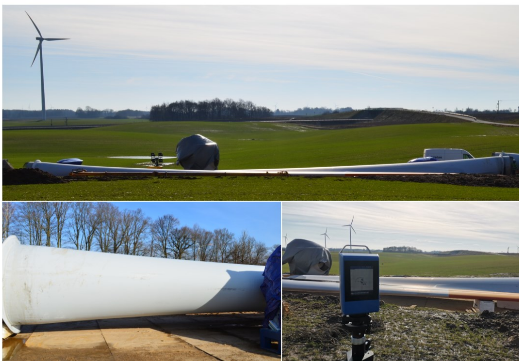
Rys. 22. Obiekt badań w Zadaniu 2. – fotografia skanowanych łopat turbin wiatrowych [114].
