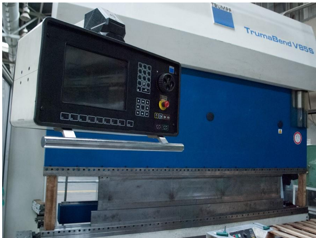
Rys. 19. Obraz prasy do wyginania blach Trumpf TrumaBend V85S
