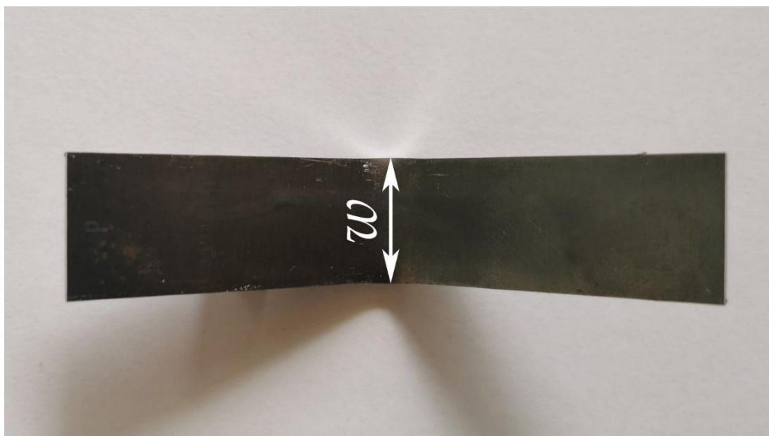
Rys. 75. Ilustracja szerokości próbki po procesie gięcia w , wykorzystanej do walidacji symulacji w zakresie odkształceń plastycznych
