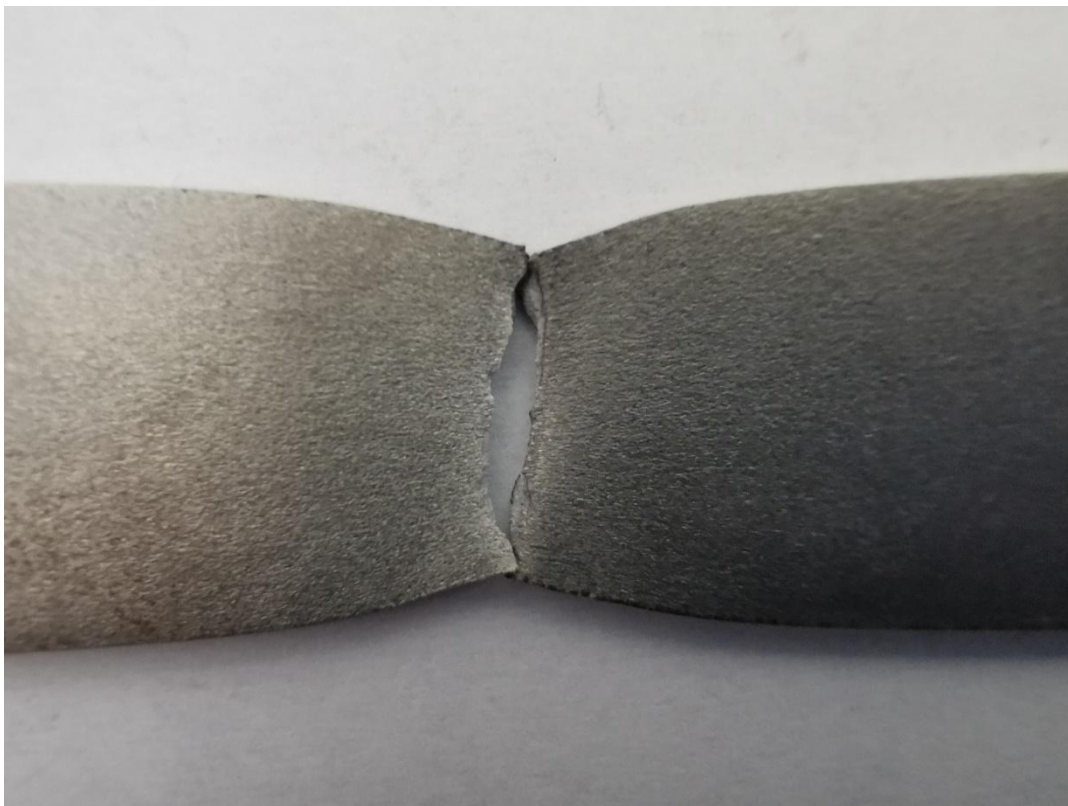
Rys. 58. Obraz strefy pęknięcia w przypadku próbki o orientacji 90^\circ
