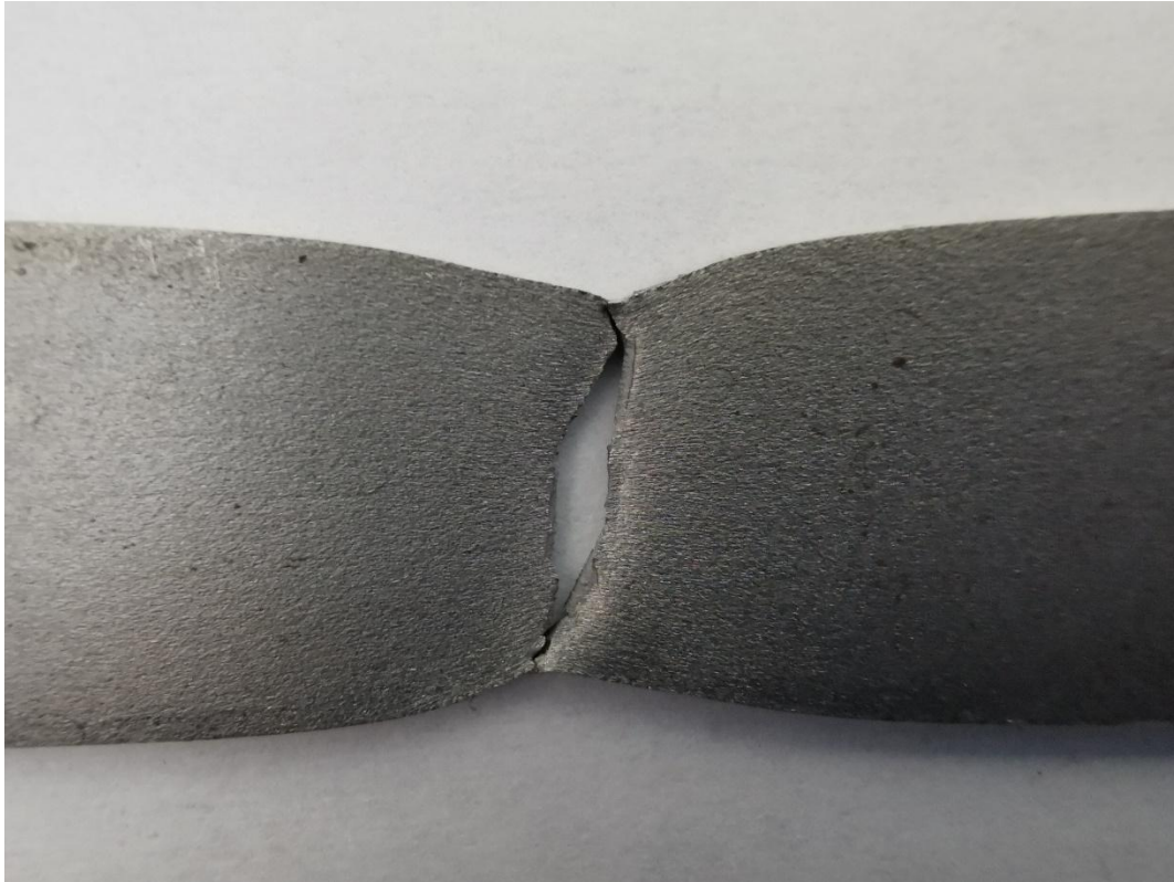
Rys. 57. Obraz strefy pęknięcia w przypadku próbki o orientacji 0^\circ
