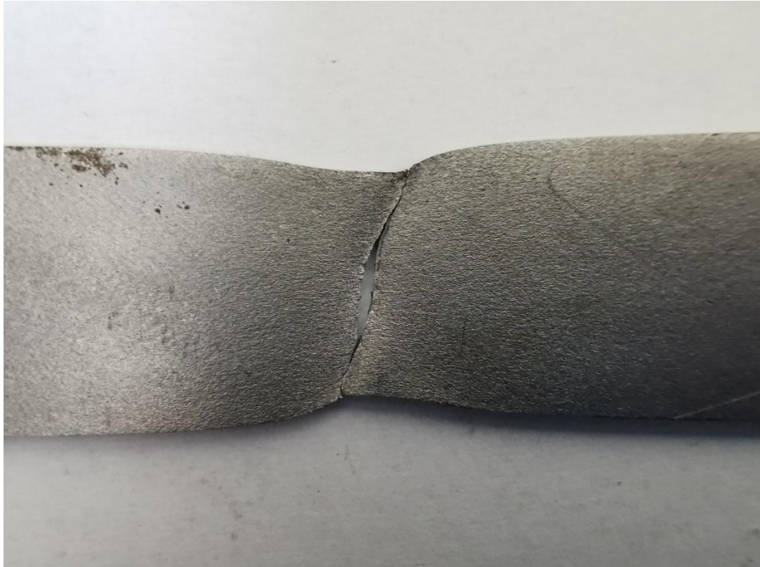
Rys. 59. Obraz strefy pęknięcia w przypadku próbki o orientacji 67,5°
