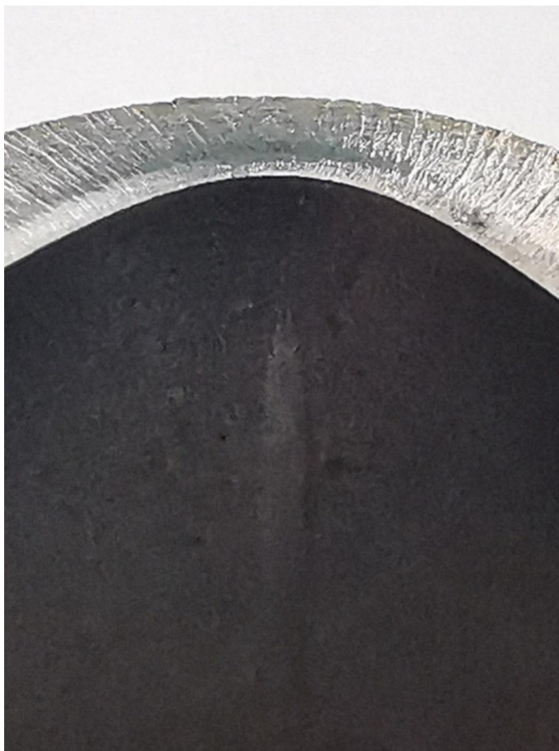
Rys. 7. Obraz brzdowania wywołanego naciskiem stempla charakterystycznego dla wyginania swobodnego
