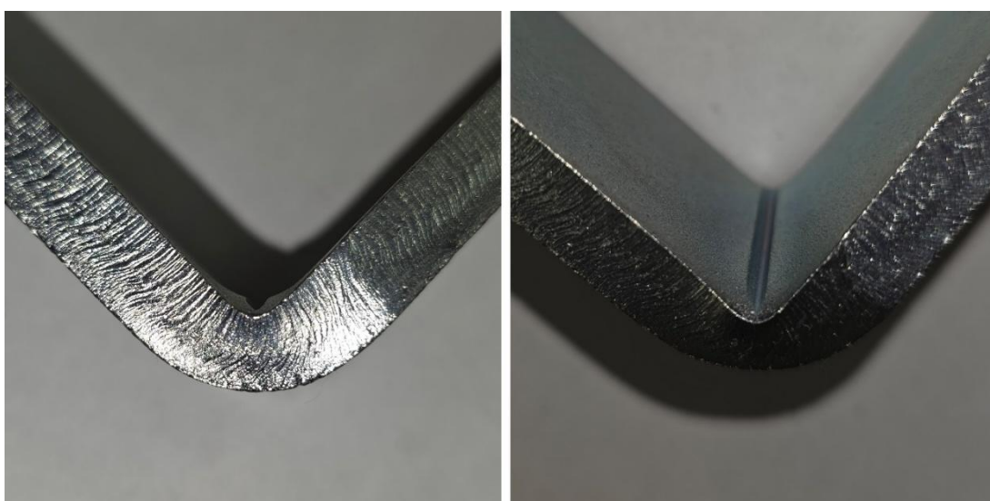
Rys. 8. Obraz bardzo głębokiej brzdy, obniżającej walory wizualne wyrobu, spowodowanej zbyt małym promieniem krawędzi stempla
