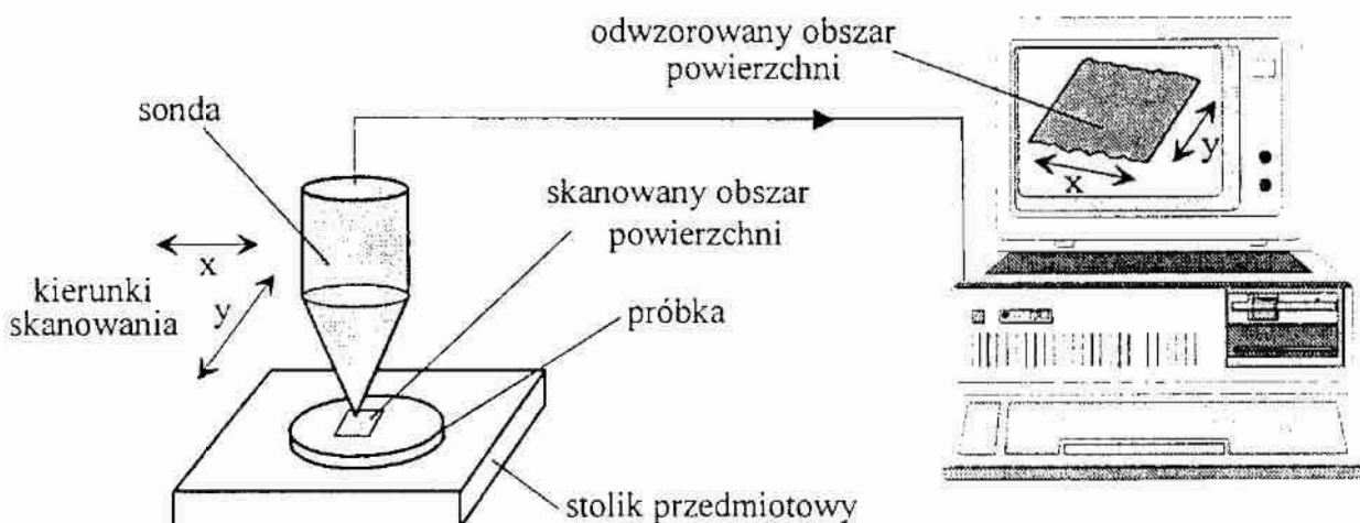
Rys. 22. Zasada działania mikroskopu z sondą skanującą Fig. 22. Principle of operation of scanning probe microscope
