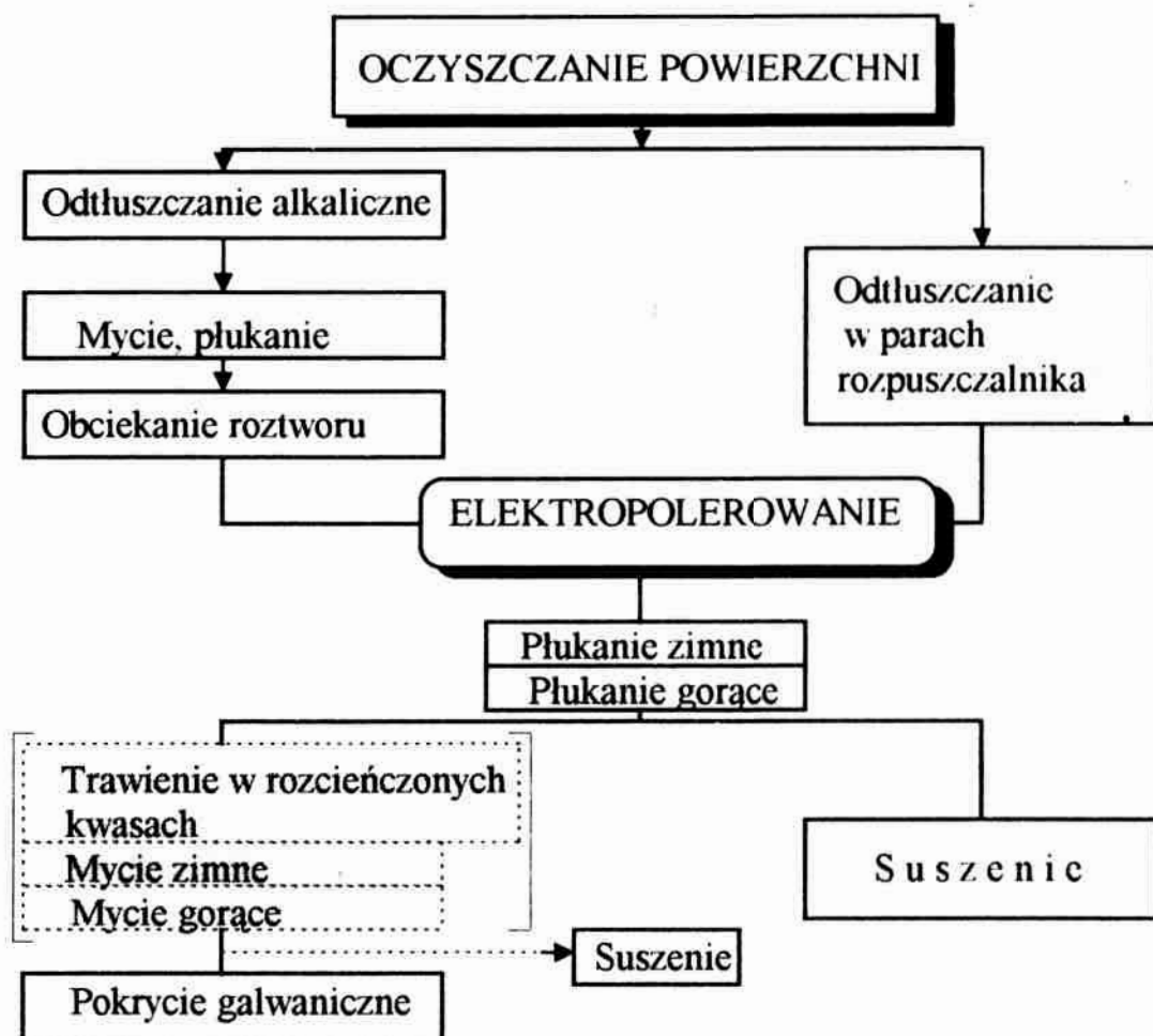
Rys. 5.13. Schemat procesu technologicznego polerowania elektrolitycznego
