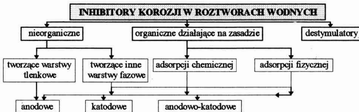
Rys. 3.39. Inhibitory korozji w roztworach wodnych [10, 40]
