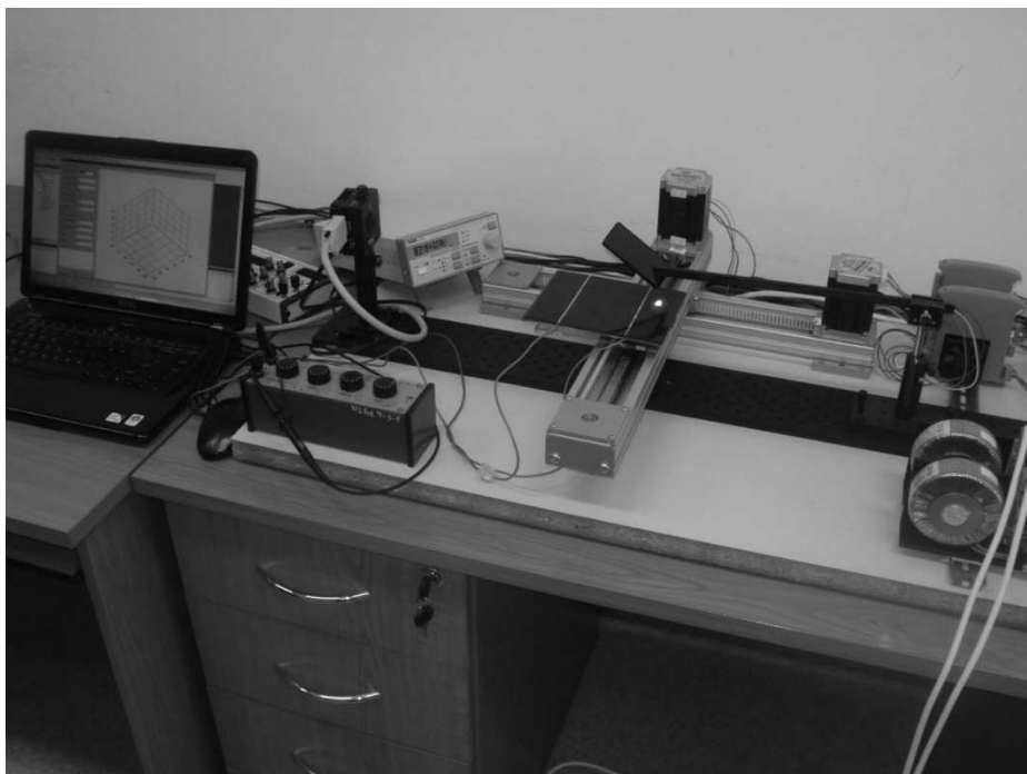
Rys. 2. Fotografia stanowiska badawczego do pomiarów ogniw fotowoltaicznych z wykorzystaniem metody punktowego indukowania prądu wiązką laserową
