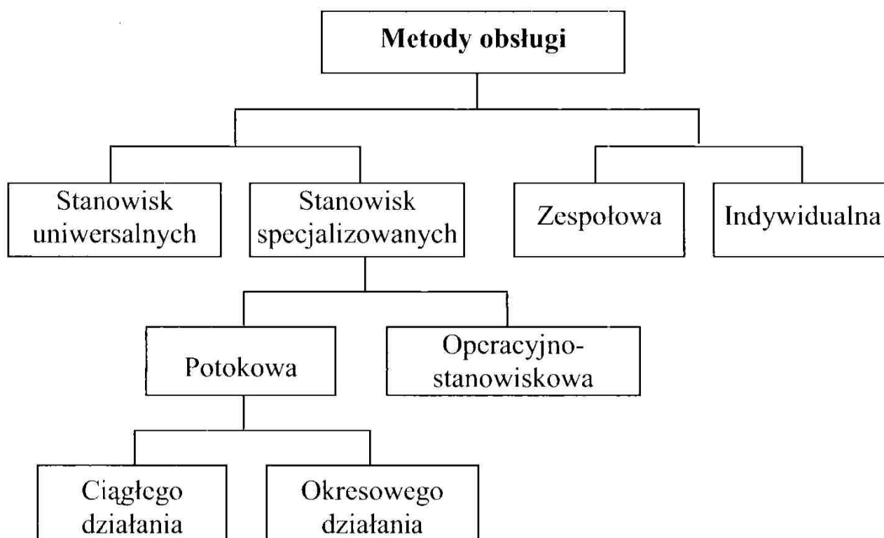
Rys. 114. Klasyfikacja metod obsługi technicznego [46]
