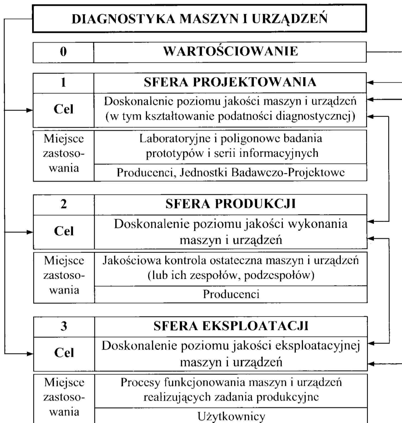
Rys. 52. Podstawowe cele stosowania diagnostyki maszyn i urządzeń oraz miejsce jej stosowania [159]
