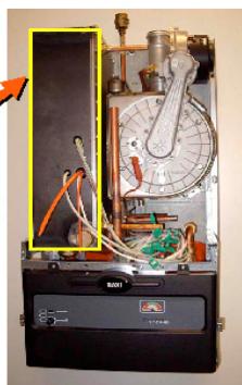
Rys. 8. Mikrośilownia z ekspanderem spiralnym
