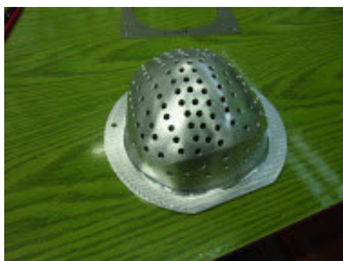
Rys. 19. Matryca metalowa, wykonana na frezarce ze sterowaniem CNC 3D
