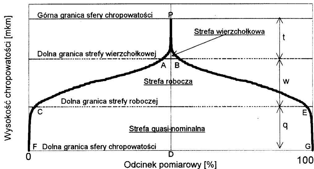
Rys. 3 – Schematyczny kształt SCGC, będącej uśrednionym przekrojem przestrzeni (sfery) chropowatości
